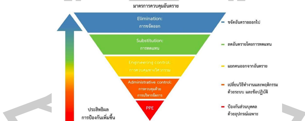
ภาพที่ 1 ลำดับชั้นของการควบคุมอันตราย (The Hierarchy of Controls)
