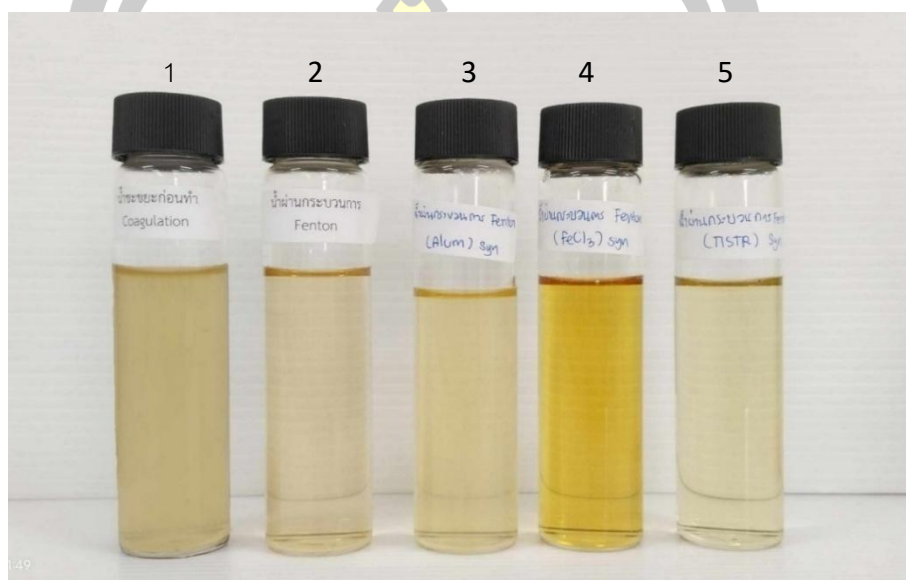
ภาพประกอบ 86 สีน้ำชะขยะสังเคราะห์ผ่านกระบวนการเฟนตันตามด้วยกระบวนการโคแอกกูเลชัน
