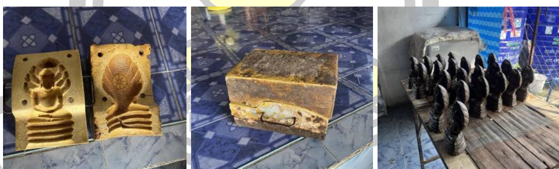
ภาพประกอบ 10 พิมพ์ที่ใช้กดพระดินเผา ที่มา: ถ่ายโดยผู้สร้างสรรค์, ณ วัดบ้านหนองแคนน้อย เมื่อ 5 ต.ค.2567
