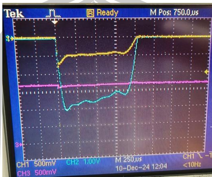
ภาพประกอบที่ 3.7 รูปแบบสัญญาณพัลส์ที่เกิดขึ้นในกระบวนการอาร์กจาก oscilloscope
