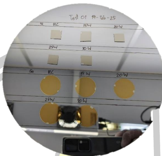
ภาพประกอบที่ 3.14 การวางตัวอย่างเพื่อทำการทดสอบเสถียรภาพทางความร้อนของฟิล์ม
