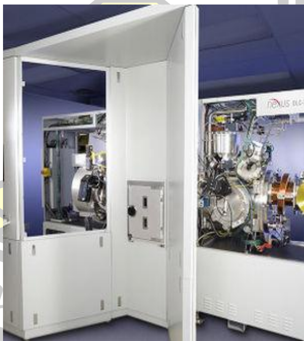
ภาพประกอบที่ 3.3 ภาพของระบบสุญญากาศสำหรับเคลือบฟิล์มบาง [66]
