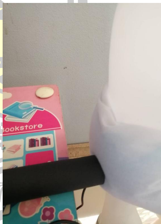
ภาพประกอบ 22 การทดลองจริงกับผิวสัมผัสของหุ่น จำนวน 10 ครั้ง เพื่อหาค่าอุณหภูมิ 10 องศาเซลเซียส ที่มีประสิทธิภาพ ในการประคบน้ำหนัก
