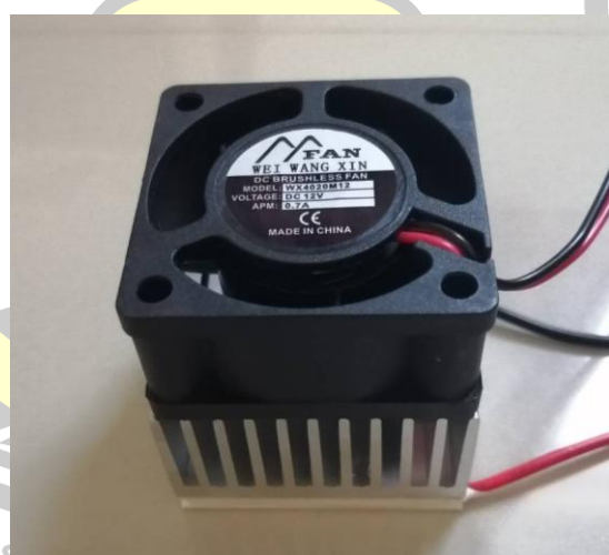
ภาพประกอบ 18 การประกอบชุดระบายความร้อน หาค่าความแตกต่างของครีป (Fin) ระบายความร้อน จำนวน 4 ขนาด โดยยึดค่าความเร็วรอบ rpm (Revolutions per minute) ที่เท่ากันของพัดลมระบายอากาศ
