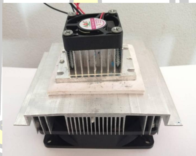
ภาพประกอบ 20 การนำ Fin และพัดลมระบายอากาศที่มีประสิทธิภาพในการระบายอากาศได้ดีที่สุดนำไปประกอบกับชุดระบายอากาศที่สามารถควบคุมอุณหภูมิได้ 10-13 องศาเซลเซียส
