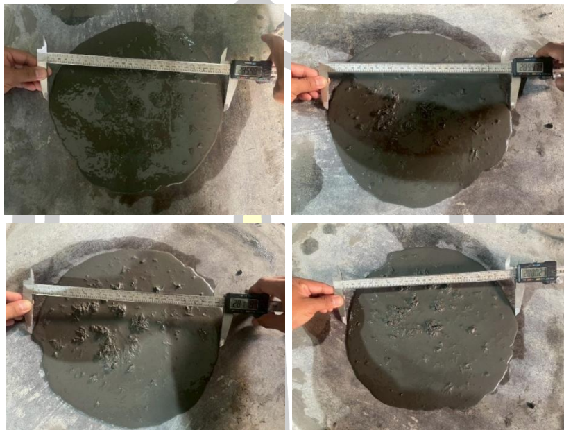
รูปที่ 57 ตัวอย่างการวัดค่าทดสอบการไหลแผ่
