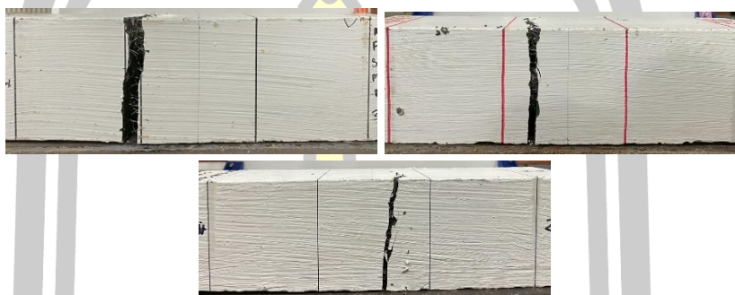
รูปที่ 39 ตัวอย่างหลังการทดสอบกำลังรับแรงดัดที่ปริมาณเส้นใยเหล็กต่างกัน
