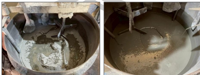
รูปที่ 13 การผสมของแห้ง และของเหลวในครั้งแรก
