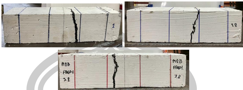
รูปที่ 37 ตัวอย่างหลังการทดสอบกำลังรับแรงดัดที่ปริมาณเถ้าลอยต่างกัน
