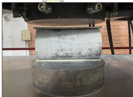
รูปที่ 22 การทดสอบกำลังรับแรงดึงแบบผ่าซีก
