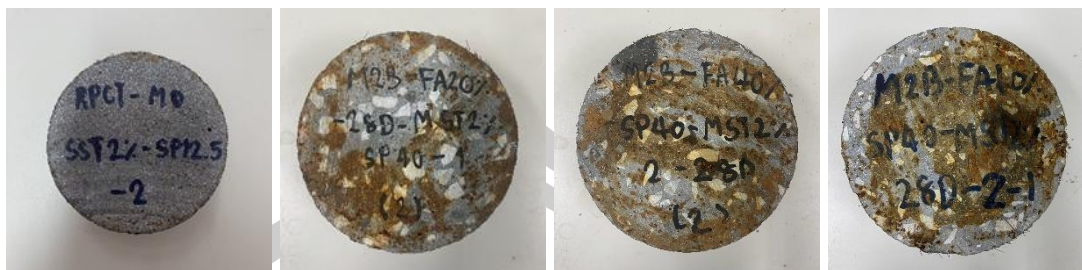
รูปที่ 42 ตัวอย่างหลังการทดสอบการซึมผ่านคลอไรด์แบบเร่ง
