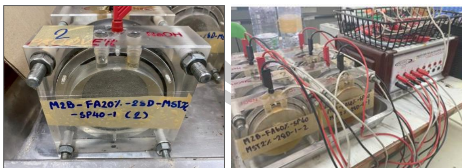
รูปที่ 26 การทดสอบการซึมผ่านของคลอไรด์แบบเร่ง
