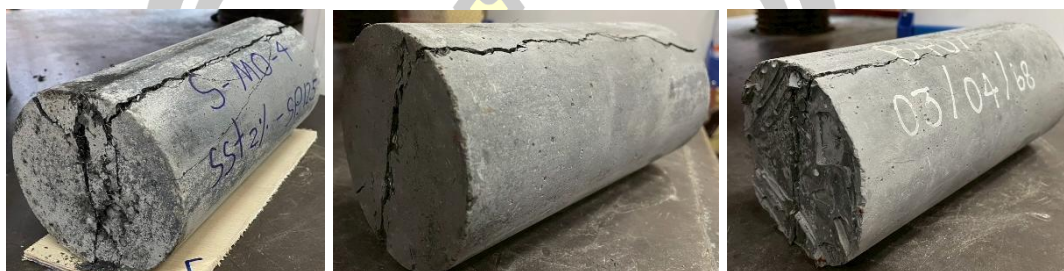
รูปที่ 33 ตัวอย่างหลังการทดสอบกำลังรับแรงดึงแบบผ่าซีกที่ปริมาณเถ้าลอยต่างกัน
