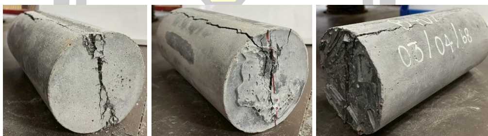
รูปที่ 35 ตัวอย่างหลังการทดสอบกำลังรับแรงดึงแบบผ่าซีกที่ปริมาณเส้นใยเหล็กต่างกัน
