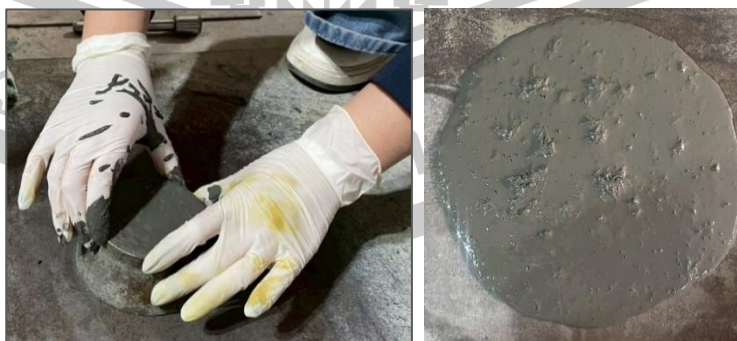
รูปที่ 18 การทดสอบการไหลแผ่
