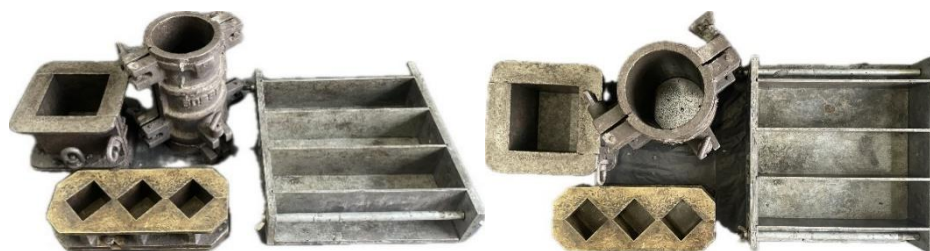
รูปที่ 10 การเตรียมแบบหล่อ
