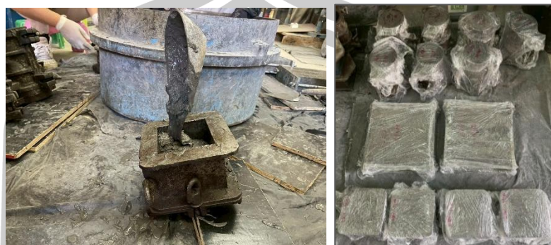
รูปที่ 19 การเทคอนกรีตเข้าแบบหล่อ (ซ้าย) การหุ้มแบบหล่อด้วยแผ่นพลาสติก (ขวา)
