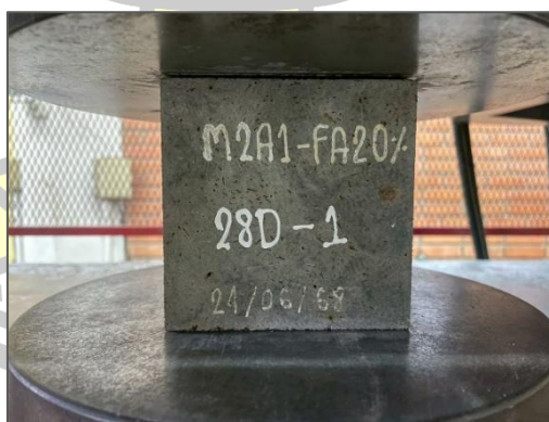
รูปที่ 21 การทดสอบกำลังรับแรงอัด
