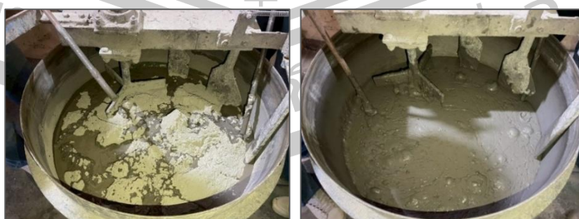
รูปที่ 15 การผสมของแห้ง และของเหลวในครั้งสุดท้าย
