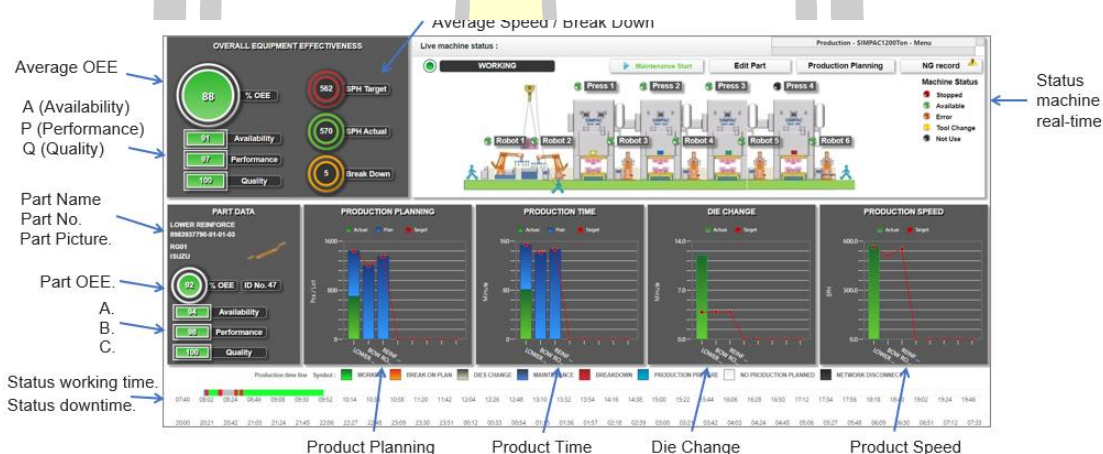
ภาพประกอบที่ 5 หน้าจอแสดงผลที่ออกแบบเพื่อวัดประสิทธิภาพการทำงานโดยรวมของเครื่องจักรผ่านระบบเครือข่ายอินเทอร์เน็ตของสรรพสิ่ง
