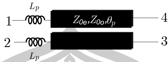
ภาพประกอบ 3.13 สายส่งเชื่อมต่อคู่ขนานแบบเชื่อมต่อตัวเหนี่ยวนำสองตัวที่พอร์ตอินพุตแลพอร์ตเชื่อมต่อ
