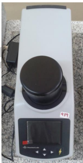
ภาพประกอบ 0.5 เครื่องวัดสี รุ่น Color Flex EZ CFEZ0939
