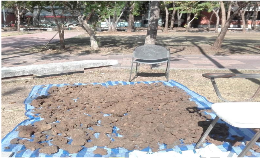
ภาพประกอบที่ 4.5 การผึ่งดินตัวอย่างที่เก็บมาได้ก่อนเริ่มทำการทดสอบ
