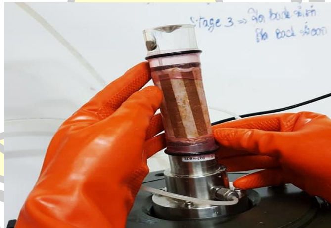
ภาพประกอบที่ 4.10 การติดตั้งตัวอย่างดินบนเครื่องทดสอบแรงอัดสามแกน
