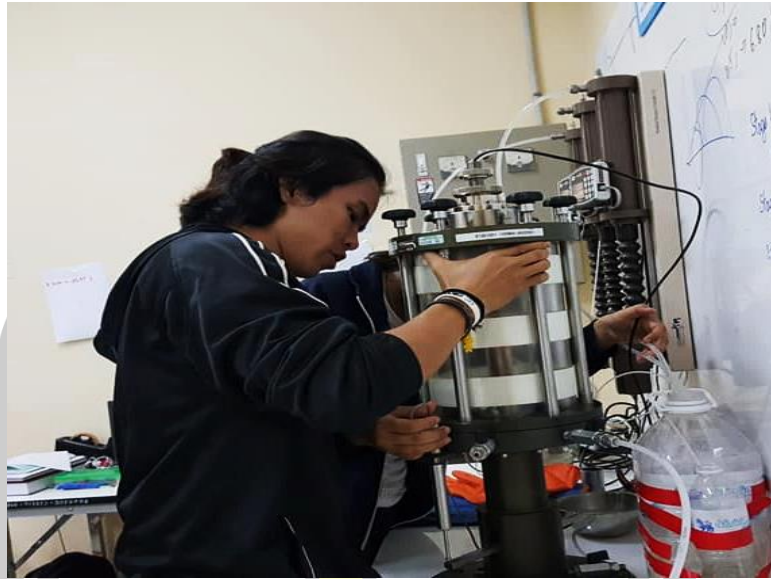
ภาพประกอบที่ 4.7 การติดตั้งเครื่องทดสอบแรงอัดสามแกน
