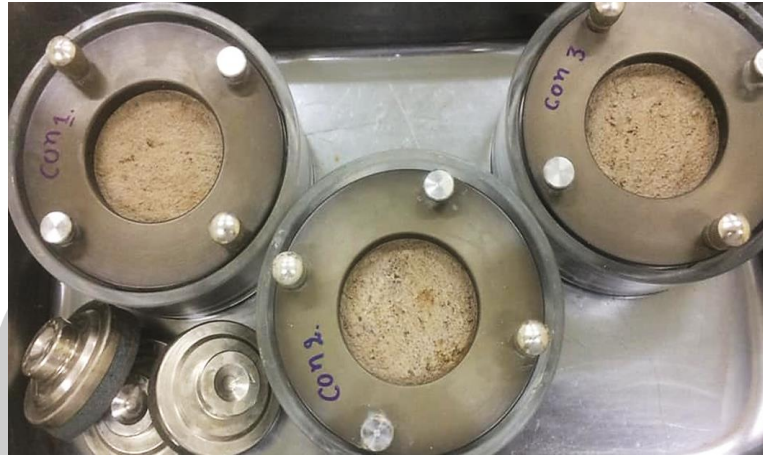
ภาพประกอบที่ 4.11 กล่องใส่ตัวอย่างดินสำหรับทดสอบการอัดตัวคายน้ำ
