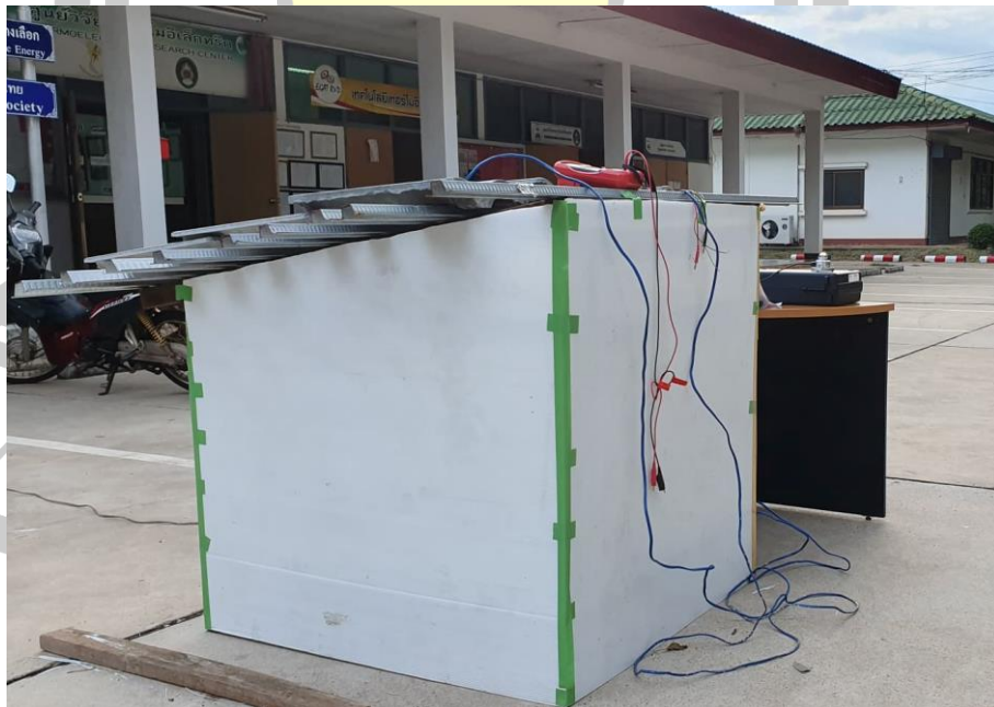
ภาพประกอบ 3.30 ด้านหลังการทดลองภาคสนามของกระเบื้องมุงหลังคาเทอร์โมอิเล็กทริก
