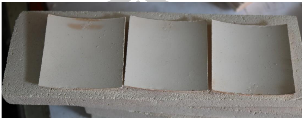
ภาพประกอบ 3.13 แผ่นดินขาว VCB ที่ได้จากการขึ้นรูปไปเผาผนึก อุณหภูมิ 950 °C เป็น เวลา 5 ชั่วโมง
