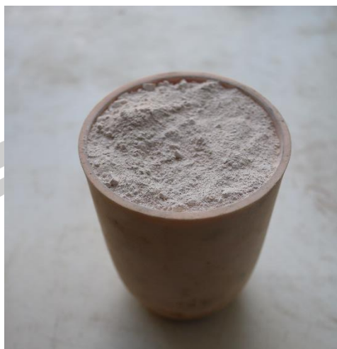
ภาพประกอบ 3.11 ดินขาวที่ผ่านการเผาไล่สิ่งเจือปน
