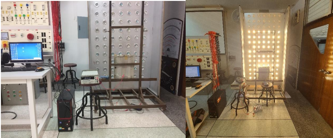
ภาพประกอบ 3.27 การทดสอบประสิทธิภาพของกระเบื้องมุงหลังคาเทอร์โมอิเล็กทริก
