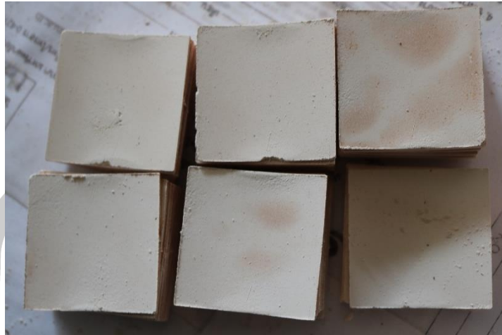
ภาพประกอบ 3.15 การผลิตแผ่นเซรามิกฐานรองเทอร์โมอิเล็กทริกมอดูลแบบ C ขนาด 30 \times 30 \text{ mm}^2
