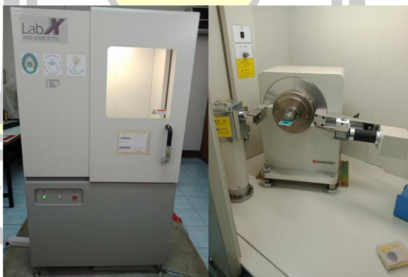
ภาพประกอบ 3.2 วิเคราะห์โครงสร้างผลึก ด้วยเทคนิคการเลี้ยวเบนของรังสีเอกซ์ ทำการวัดที่ศูนย์ความเป็นเลิศด้านพลังงานทางเลือก (ศลพ.) สถาบันวิจัยและพัฒนา มหาวิทยาลัยราชภัฏสกลนคร
