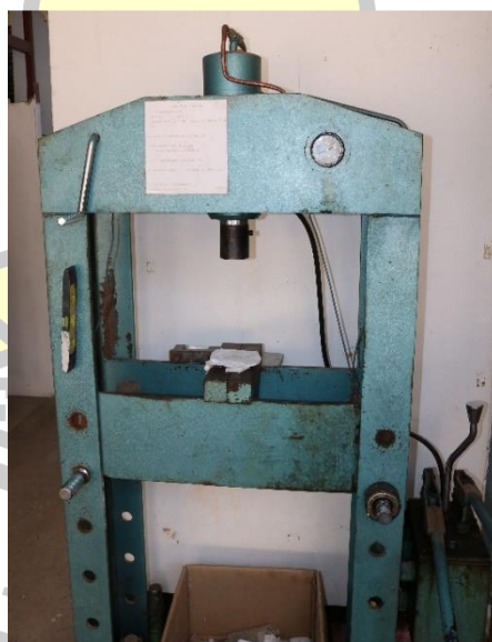
ภาพประกอบ 3.12 ขึ้นรูปด้วยเครื่องอัดไฮดรอลิก
