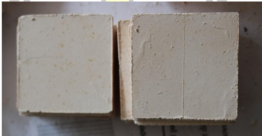
ภาพประกอบ 3.16 การผลิตแผ่นเซรามิกฐานรองเทอร์โมอิเล็กทริกมอดูลแบบ B ขนาด 30 \times 30 \text{ mm}^2 แบบเรียบ
