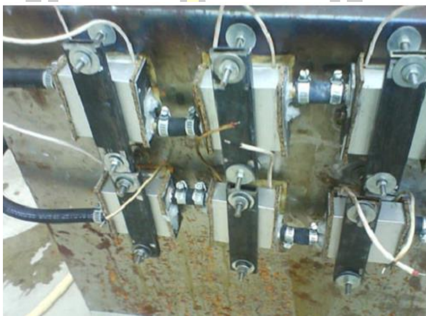
ภาพประกอบ 2.11 การประกอบเทอร์โมอิเล็กทริกมอดูลเข้ากับเตาให้ความร้อนภายในบ้าน และระบบระบายความร้อนด้วยน้ำ
