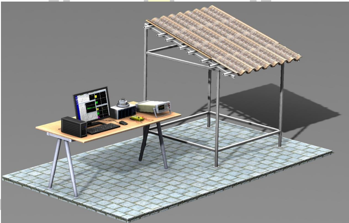
ภาพประกอบ 3.28 ส่วนประกอบในการทดลองภาคสนามของกระเบื้องมุงหลังคาเทอร์โมอิเล็กทริก
