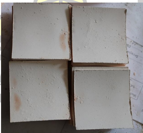
ภาพประกอบ 3.14 การผลิตแผ่นเซรามิกฐานรองเทอร์โมอิเล็กทริกมอดูลแบบ A ขนาด 50 x 50 mm 2
