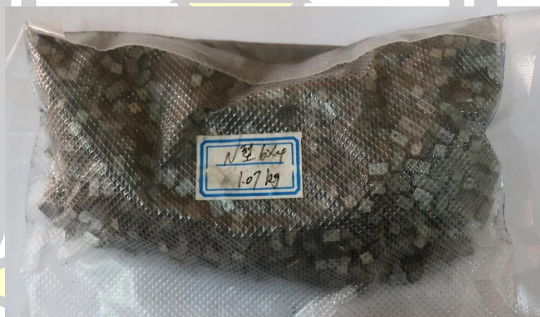
ภาพประกอบ 3.18 เทอร์โมอิเล็กทริกชนิดเอ็น คือ n-type \text{Bi}_{0.58}\text{Te}_{1.42}
