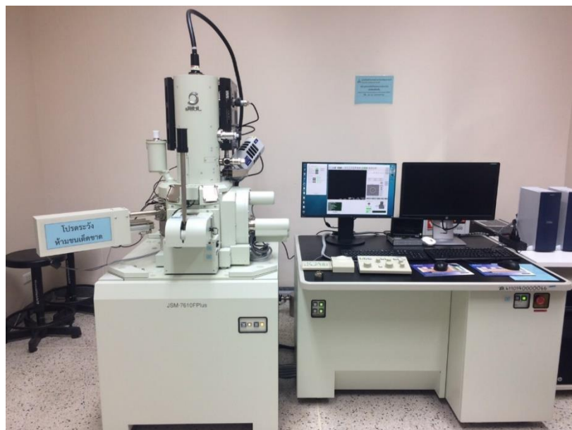
ภาพประกอบ 3.1 กล้องจุลทรรศน์อิเล็กตรอนแบบส่องกราดชนิดฟิลด์อิมิสชัน ทำการวัดที่ ศูนย์เครื่องมือวิทยาศาสตร์ มหาวิทยาลัยอุบลราชธานี
