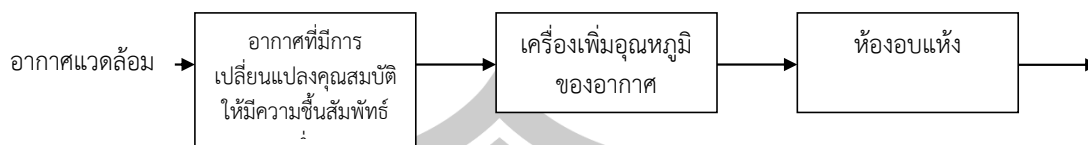
ภาพประกอบ 3.18 ขั้นตอนการอบแห้งด้วยอากาศที่ผ่านการลดความชื้นอากาศ
