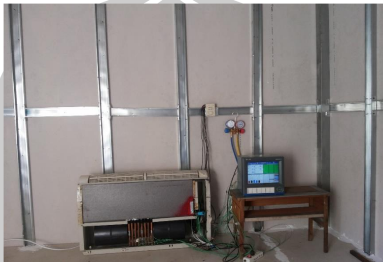
ภาพประกอบ 27 การติดตั้งอุปกรณ์ทำความร้อนแบบ VFT กับคอยล์เย็นในเครื่องปรับอากาศแบบแยกส่วน
