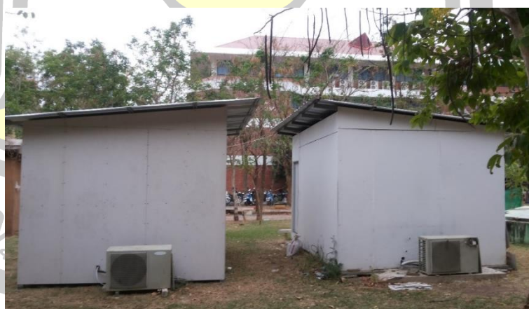
ภาพประกอบ 28 ห้องทดสอบอุปกรณ์ทำความร้อนแบบ VFT เข้ากับคอยล์เย็นในของเครื่องปรับอากาศแบบแยกส่วน
