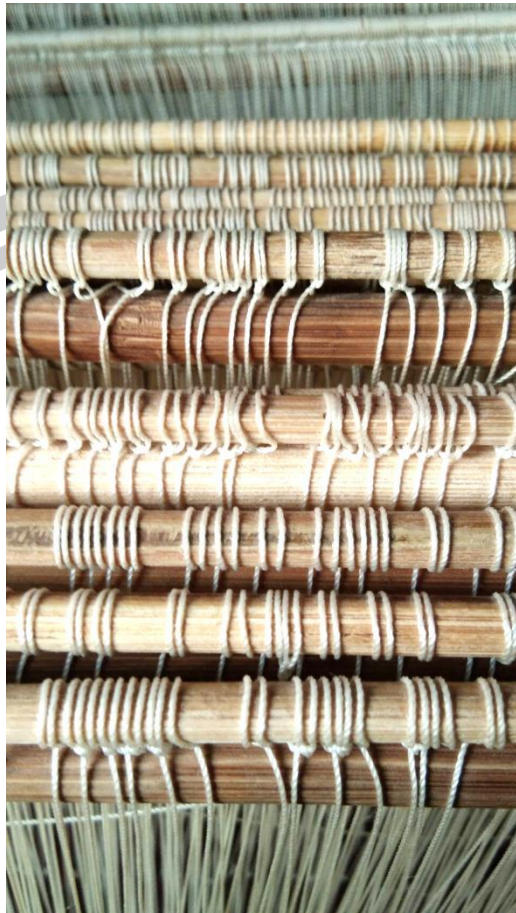
ภาพประกอบ 51 ไม้ไผ่ที่นำมาใช้ทำเขาและตะกอล
