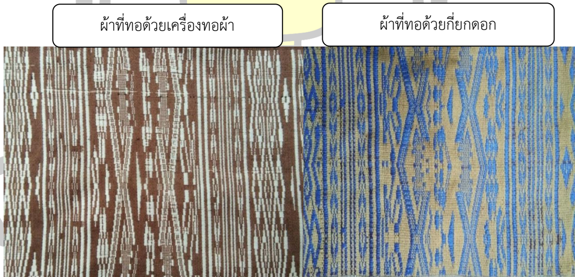
ภาพประกอบ 130 การหาจุดตำหนิเปรียบเทียบระหว่างฝ้ายกดอกที่ทด้วยก๊วยกดอกและเครื่องทอผ้า
