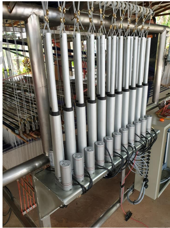
ภาพประกอบ 58 ติดตั้งมอเตอร์สกรูบนแท่นวางมอเตอร์
