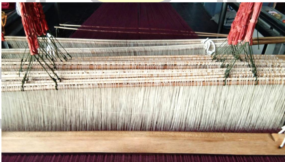
ภาพประกอบ 52 ไม้ไผ่นำมาสอดเข้าตะกอลและเขาเพื่อเพิ่มความแข็งแรง
