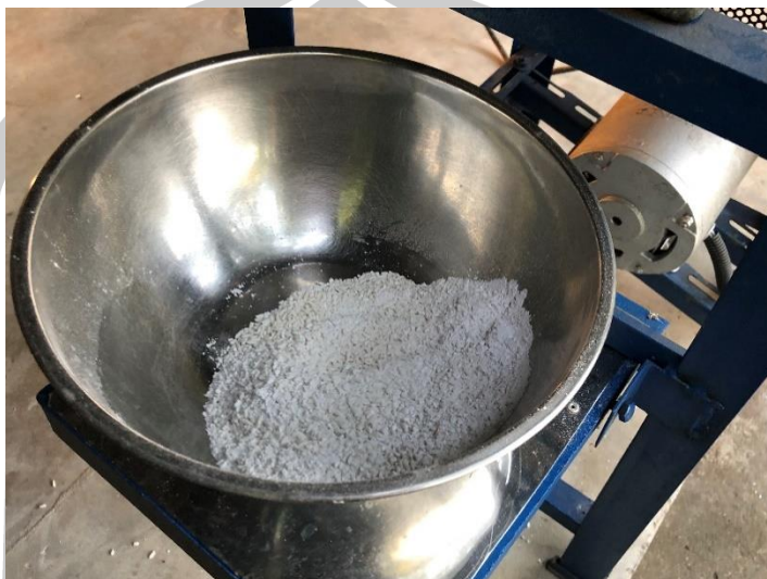
ภาพประกอบ 54 ตัวอย่างขนาดและรูปร่างของยิปซัมบด
