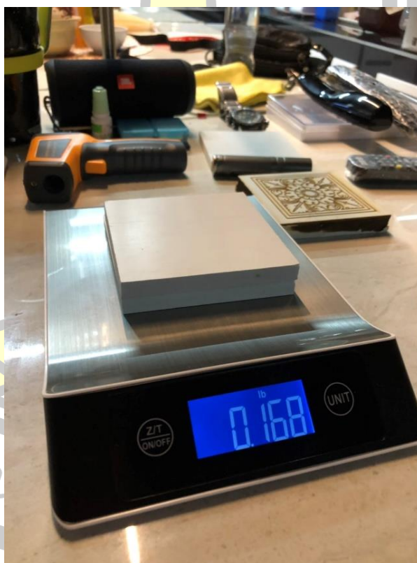
ภาพประกอบ 59 ตัวอย่างอัตราส่วนผสมที่มียิปซั่มบดมากกว่าร้อยละ 50 ขนาด 10x10x1 เซนติเมตร
