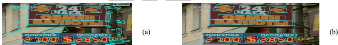
รูปที่ 96 การตรวจหาข้อความบนพื้นฐานของ SVM จากรูป (a) เป็นผลของการตรวจหาข้อความต้นฉบับ และ (b) เป็นผลลัพธ์ของการตรวจหาข้อความที่ได้รับการฝึกด้วย SVM
