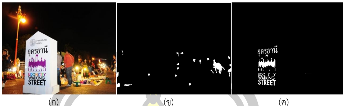
รูปที่ 130 ภาพผลลัพธ์ของวิธีการ Maximally Stable Extremal Regions ที่นำมาใช้กับภาพที่มีพื้นหลังซับซ้อน (ก) ภาพต้นฉบับ (ข) ภาพ MSER ที่ใช้ค่าพารามิเตอร์มาตรฐาน และ (ค) ภาพ MSER ที่มีการกำหนดค่าพารามิเตอร์ด้วยมือ
