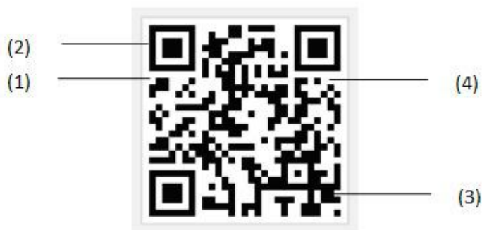
ภาพประกอบที่ 18 โครงสร้างของคิวอาร์โค้ด
