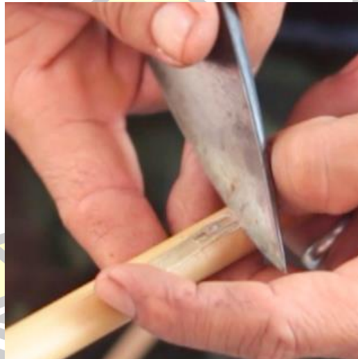
ภาพประกอบ 36 การทำให้ลื่นแคนเรียบโดยใช้มีดชูด
