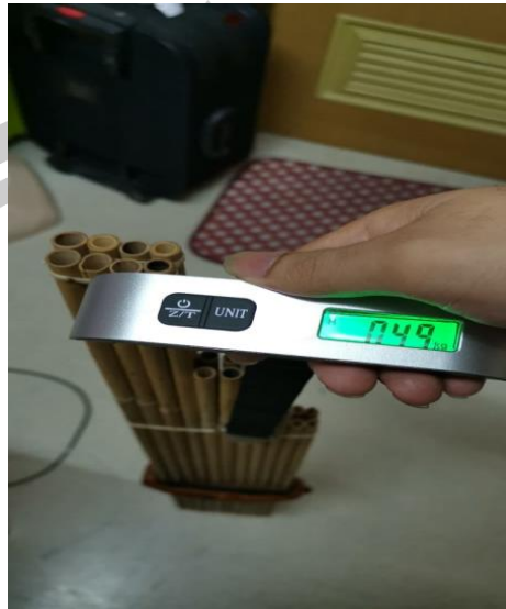
ภาพประกอบ 77 ชั่งน้ำหนักแคนระบบเสียงโครมาติก รุ่นที่ 2 ด้วยน้ำหนัก 0.49 กิโลกรัม ที่มา : ชุมชน สีสวงค์
