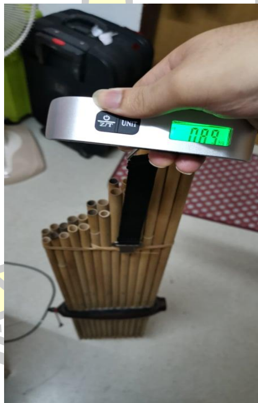
ภาพประกอบ 68 ชั่งน้ำหนักแคนโครมาติก รุ่นที่ 1 ด้วยน้ำหนัก 0.89 กิโลกรัม
