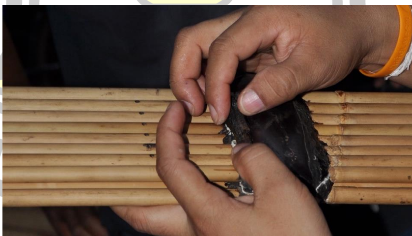
ภาพประกอบ 42 การนำขี้สุตมาอุดรู และช่องว่างไม้กู่แค้นกับเต้าแค้น ที่มา : ชุมชน สীবวงศ์
