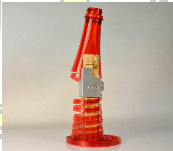
ภาพประกอบ 10 นำขวดพลาสติกเข้าสู่เครื่องรีดเส้น
