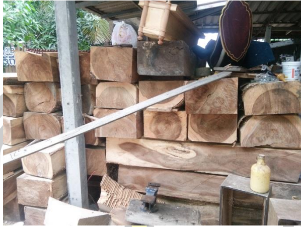
ภาพประกอบ 36 ท่อนไม้ก้ามปูหรือไม้จามจूरสำหรับเตรียมทำห้องต้องมีลักษณะสีน้ำตาลเข้ม
