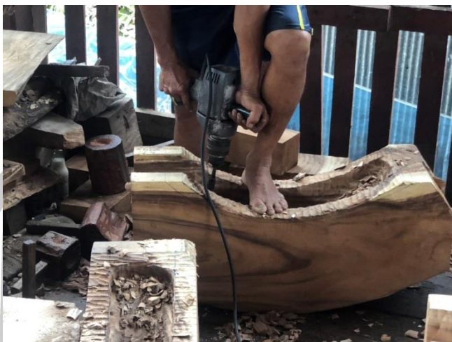
ภาพประกอบ 55 การใช้สว่านไฟฟ้าเจาะ เพื่อขุดราง
