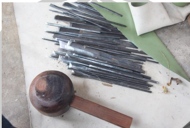
ภาพประกอบ 43 ส่วขนาดต่าง ๆ และ ค้อนไม้สำหรับตอกส่ว
