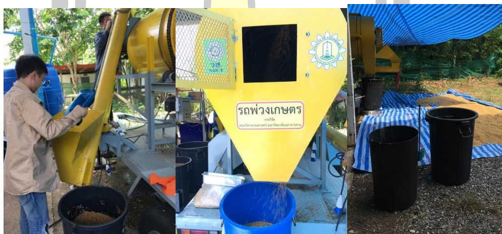
ภาพประกอบ จ.4 อบลดความชื้นด้วยเครื่องอบแห้งแบบถังทรงกระบอกหมุนด้วยระบบรังสีอินฟราเรดร่วมกับลมร้อนปล่อยทิ้ง
