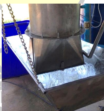
ภาพประกอบ 4.6 ลักษณะการเติมออกซิเจนในระหว่างน้ำไหลลงสู่รางรับน้ำ
