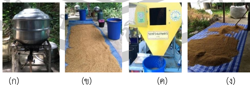
ภาพประกอบ 3.9 วิธีการนึ่ง (ก) ผึ่ง (ข) อบลดความชื้น(ค) และตากในที่ร่ม (ง)
