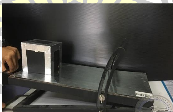
ภาพประกอบ 3.2 ภาพการทดสอบหามุมเสียดทานสถิต
