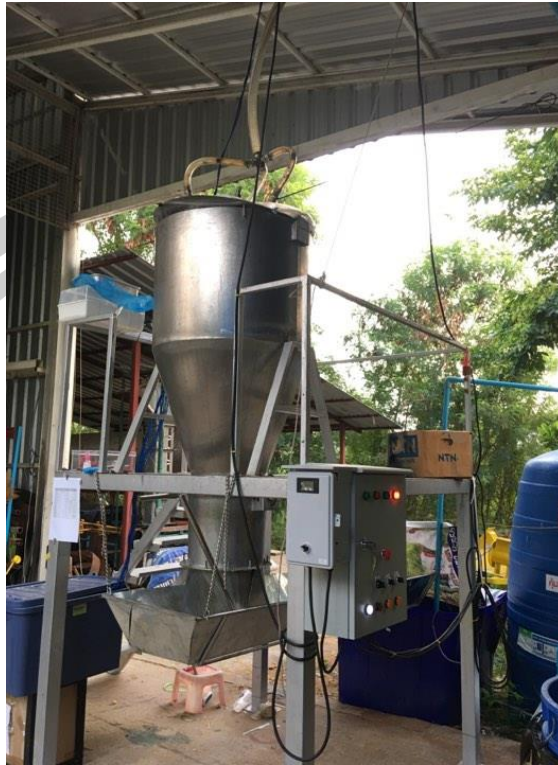
ภาพประกอบ จ.1 เครื่องแช่และเพาะงอกข้าวเปลือก
