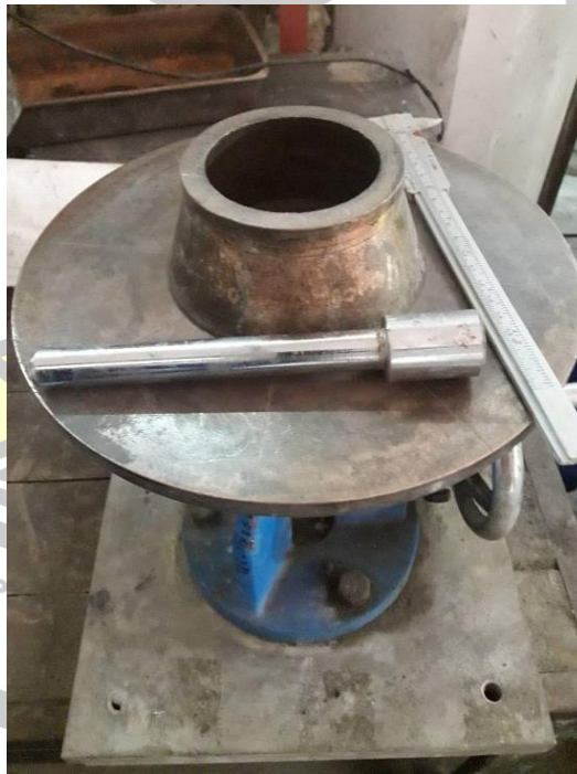
ภาพประกอบ ค 10 ชุดทดสอบหาค่าการไหลแผ่ของมอร์ต้าร์
