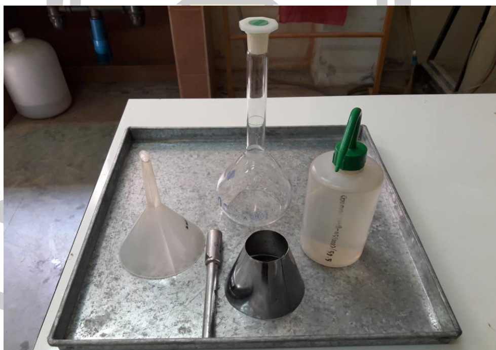
ภาพประกอบ ค 4 ชุดทดสอบหาค่าการดูดซึ่มของทราย
