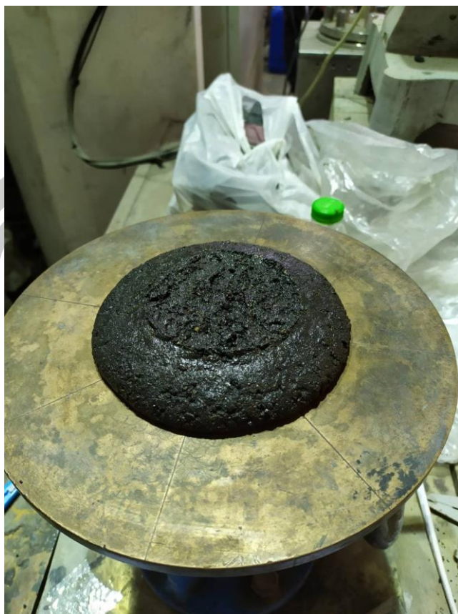
ภาพประกอบ ค 17 ทดสอบการไหลแผ่ของจีโอโพลิเมอร์มอร์ตาร์
