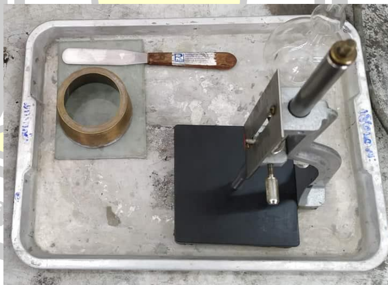
ภาพประกอบ ค 17 ทดสอบการไหลแผ่ของจีโอโพลิเมอร์มอร์ตาร์
