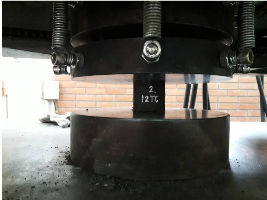
ภาพประกอบ ค 15 การทดสอบกำลังรับแรงอัดก้อนตัวอย่าง
