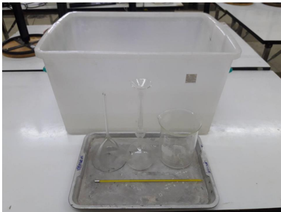
ภาพประกอบ ค 7 ชุดทดสอบหาค่าความถ่วงจำเพาะของเถ้าชานอ้อย
