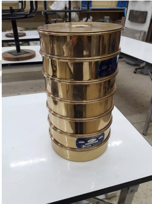
ภาพประกอบ ค 9 ชุดทดสอบหาค่าโมดูลัสความละเอียดของทราย
