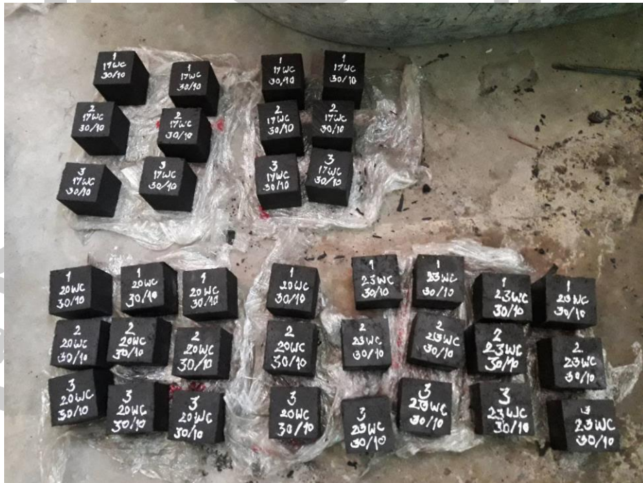
ภาพประกอบ ค 14 ลักษณะจีไอโพลีเมอร์มอร์ตาร์ที่แกะออกจากแบบหล่อ
