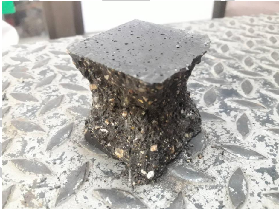
ภาพประกอบ ค 16 ลักษณะการวิบัติของก้อนตัวอย่าง
