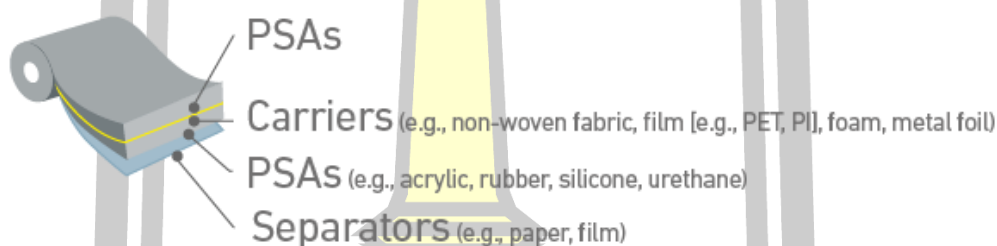
ภาพประกอบ 1 ส่วนประกอบของกาว pressure sensitive adhesives (PSAs) [28]
