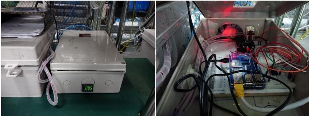
ภาพประกอบ 21 เครื่องวัดแรงกดด้วยตัวตรวจจับความดันอากาศในกระบอกสูบ
