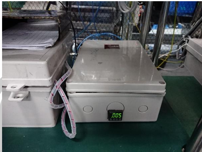
ภาพประกอบ 35 กล่องควบคุมระบบการวัดแรงกดของเครื่องกดชิ้นงานแบบเวลาจริงด้วยตัวตรวจจับแรงดันในกระบอกสูบ
