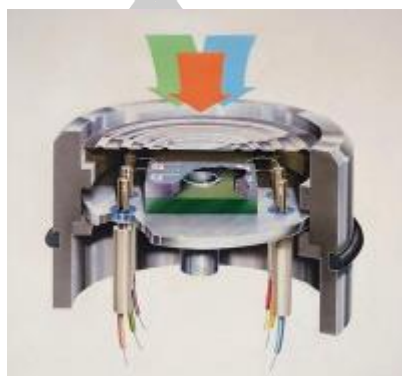
ภาพประกอบ 7 โหลดเซลล์แบบไพโซรีซิสทีฟ [8]
