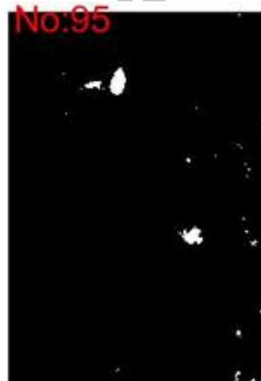
ภาพประกอบ 70 ผลการใช้กระบวนการทางภาพเพื่อหาพื้นที่ปมบนเส้นใย ของ A21
