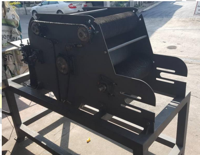
ภาพประกอบ 58 เครื่องสานเส้นใยเมื่อติดตั้งลูกกลิ้งต่างๆและหัวหนามสางแล้ว
