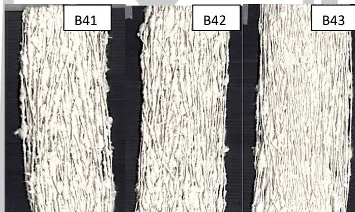
ภาพประกอบ 92 เส้นด้ายปั่นจากรังไหมที่ไม่ถูกตัดก่อนต้มลอกกว ป้อน 4 รอบต่อนาที
