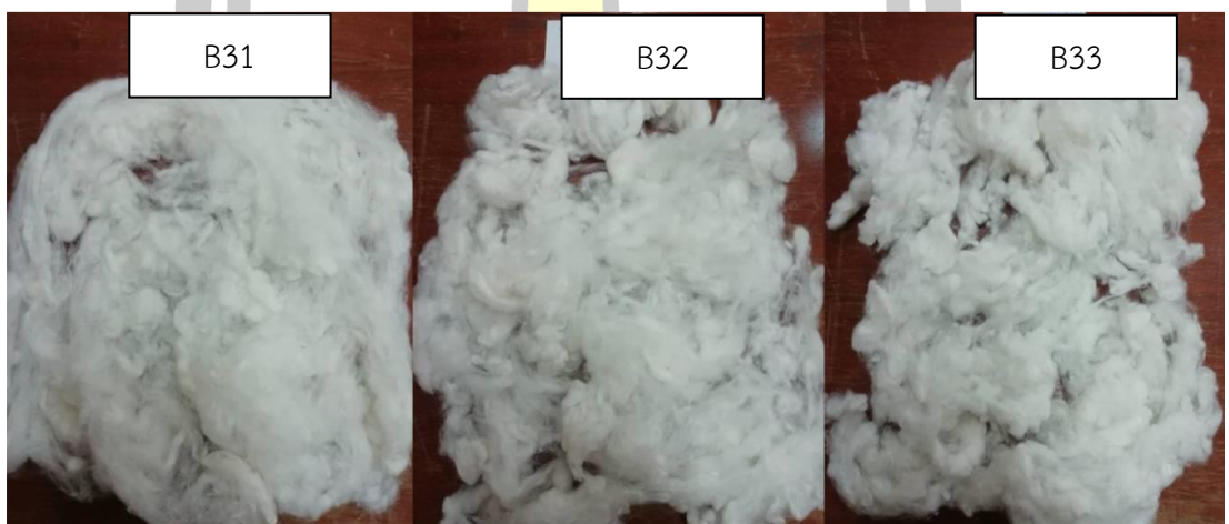
ภาพประกอบ 67 ผลของการสาងเส้นใยเมื่อลูกกิ่งป้อนหมุน 3RPM
