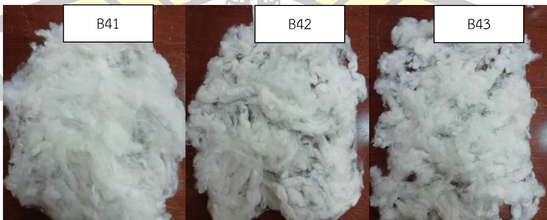
ภาพประกอบ 68 ผลของการสาងเส้นใยเมื่อลูกกิ่งป้อนหมุน 4RPM
