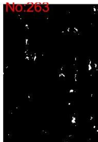
ภาพประกอบ 75 ผลการใช้กระบวนการทางภาพเพื่อหาพื้นที่ปมบนเส้นใย ของ A33
