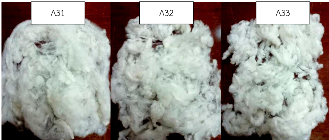
ภาพประกอบ 63 ผลของการสานเส้นใยเมื่อลูกกิ้งป้อนหมุน 3RPM
