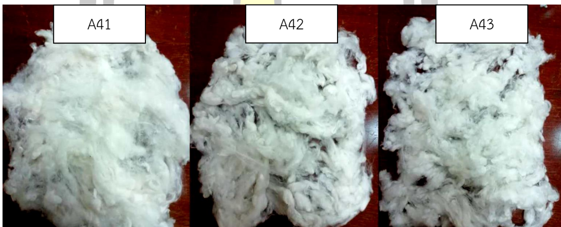
ภาพประกอบ 64 ผลของการสานเส้นใยเมื่อลูกกิ้งป้อนหมุน 4 RPM
