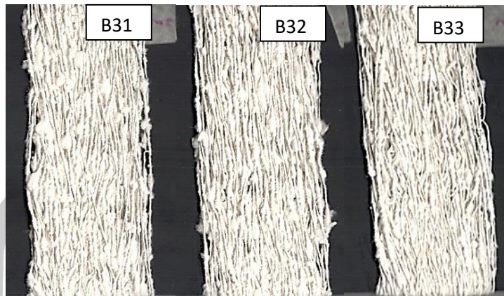
ภาพประกอบ 91 เส้นด้ายปั่นจากรังไหมที่ไม่ถูกตัดก่อนต้มลอกกว ป้อน 3 รอบต่อนาที
