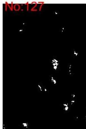
ภาพประกอบ 73 ผลการใช้กระบวนการทางภาพเพื่อหาพื้นที่ปมบนเส้นใย ของ A31
