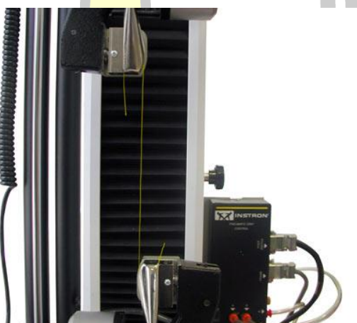
ภาพประกอบ 8 เครื่องมือทดสอบความแข็งแรงของเส้นใยและเส้นด้าย
