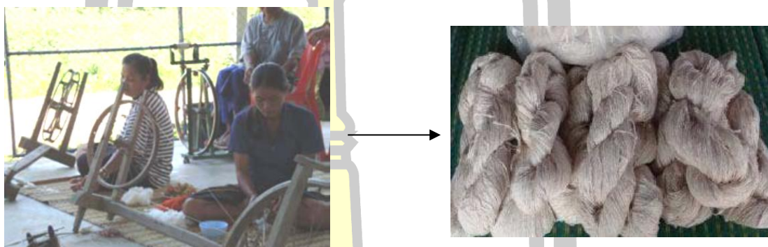
ภาพประกอบ 27 การปั่นเส้นไหมด้วยเครื่องปั่นฝ้าย
