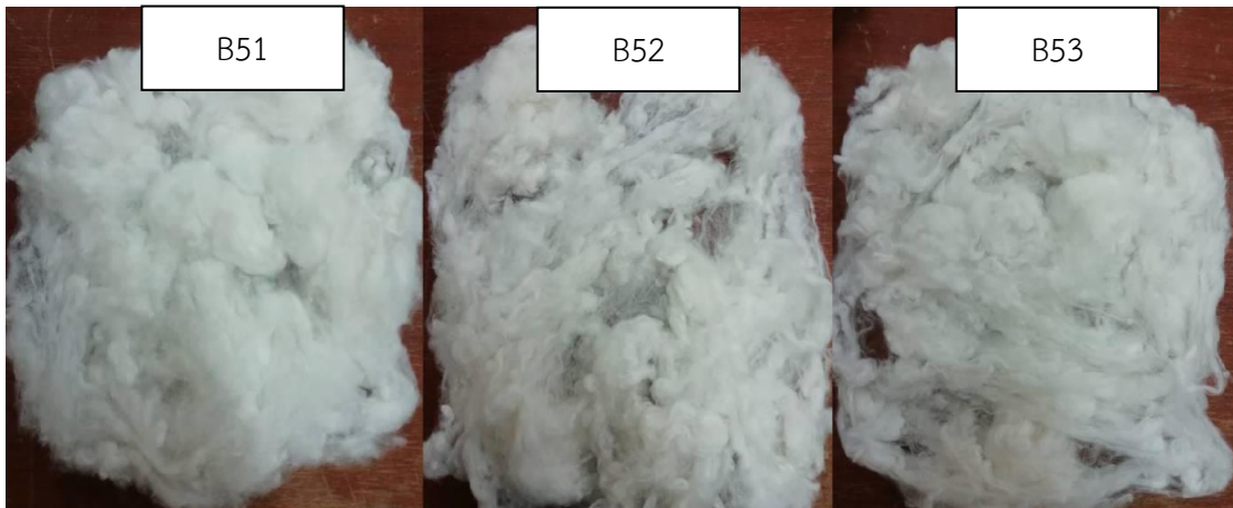
ภาพประกอบ 69 ผลของการสาងเส้นใยเมื่อลูกลิ้งป้อนหมุน 5RPM
