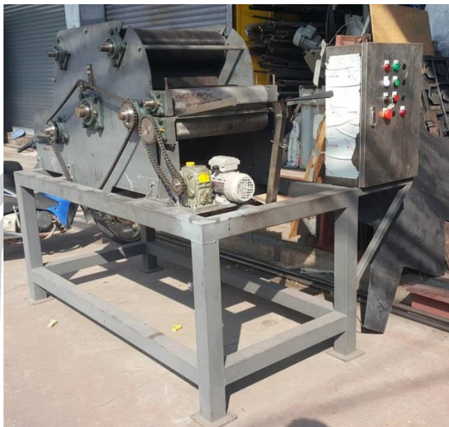
ภาพประกอบ 59 การติดตั้งมอเตอร์และตู้ควบคุมกับเครื่องสาងเส้นใย
