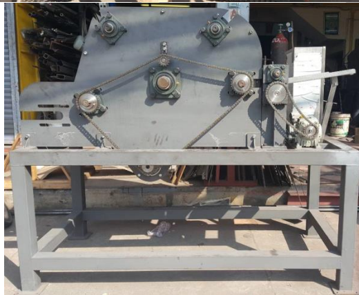
ภาพประกอบ 57 ภาพด้านบนและภาพด้านข้างเมื่อติดตั้งลูกกลิ้งต่างๆและหัวหนามสางแล้ว
