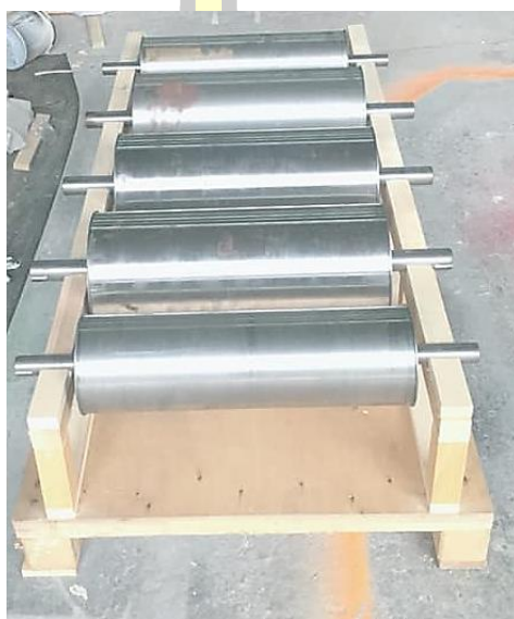
ภาพประกอบ 53 แกนด้านในของ ลูกกลิ้ง หัวหนามสางและหัวม้วนเก็บ
