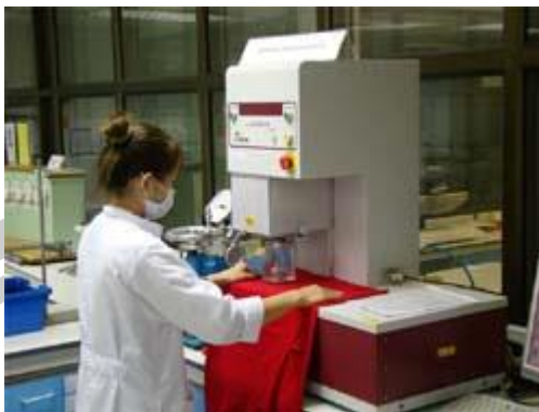
ภาพประกอบ 9 เครื่องมือทดสอบน้ำหนักของผ้าและหาจำนวนเส้นด้าย
