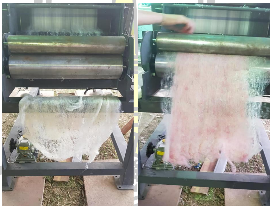
ภาพประกอบ 102 ตัวอย่างการทำงานการสาวเส้นใยของเครื่อง
