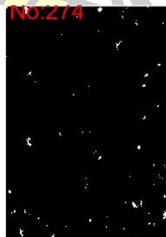
ภาพประกอบ 80 ผลการใช้กระบวนการทางภาพเพื่อหาพื้นที่ปมบนเส้นใย ของ A 52
