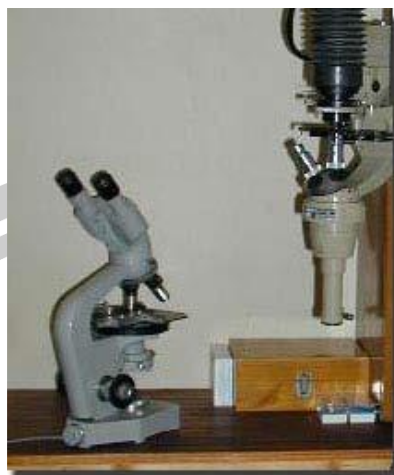
ภาพประกอบ 7 เครื่องมือสำหรับหาขนาดของเส้นใย เส้นด้าย
