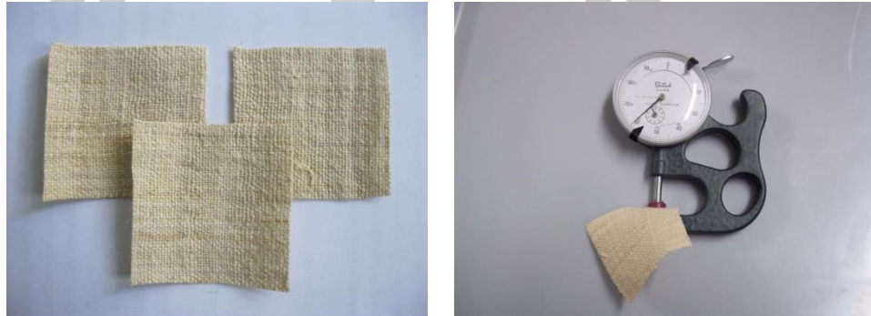
ภาพประกอบ 15 ผืนผ้าตัวอย่างและอุปกรณ์วัดความหนาของผืนผ้า[50]
