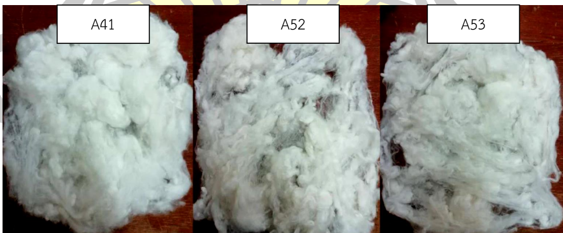
ภาพประกอบ 65 ผลของการสานเส้นใยเมื่อลูกกิ้งป้อนหมุน 5RPM
