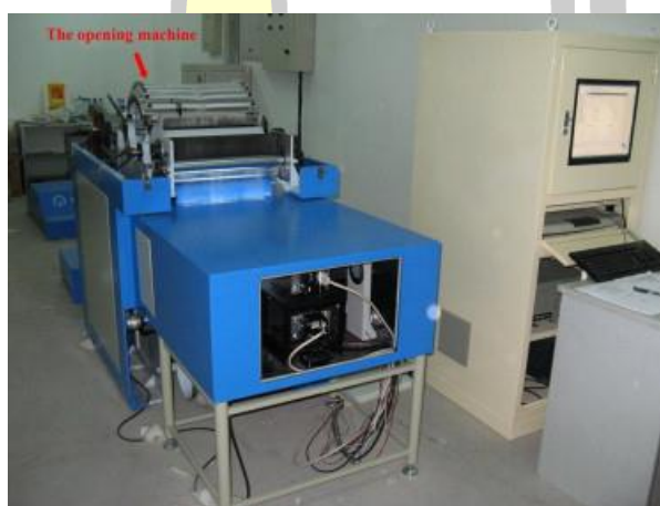
ภาพประกอบ 24 เครื่องมือที่ใช้ในการตรวจสอบแบบอัตโนมัติเพื่อหาเส้นใยแปลกปลอม [60]
