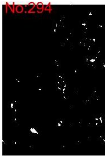
ภาพประกอบ 72 ผลการใช้กระบวนการทางภาพเพื่อหาพื้นที่ปมบนเส้นใย ของ A23
