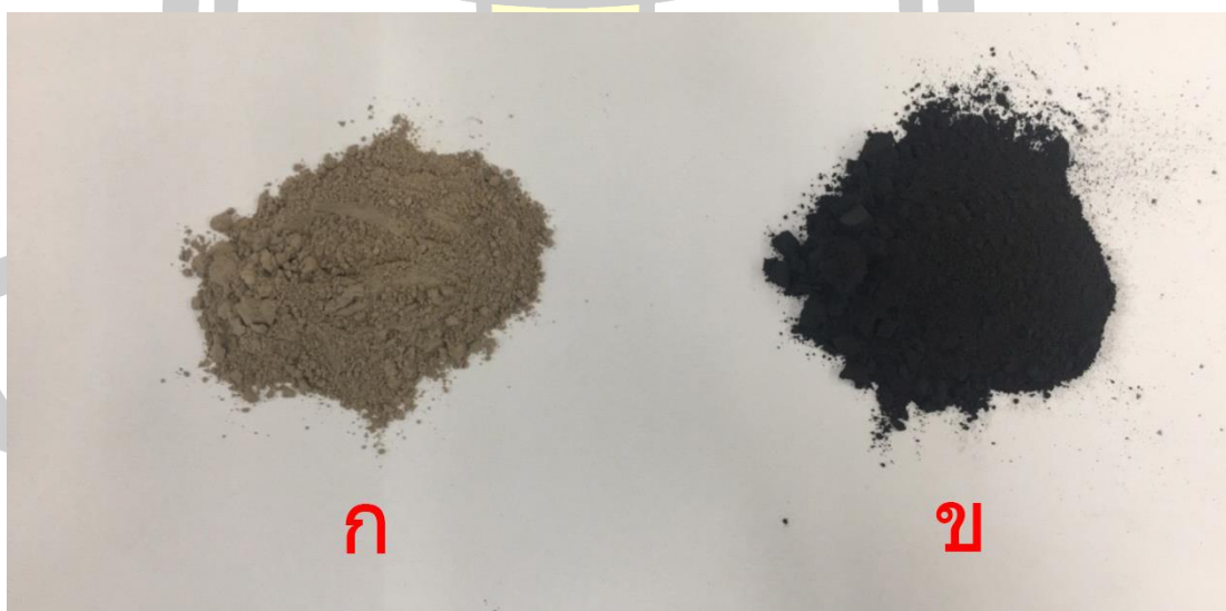
ภาพประกอบที่ 15 ลักษณะของวัตถุดิบหลังผ่านตะแกรงเบอร์ 100 (ก) ดินเหนียว และ (ข) เถ้าหนัก
