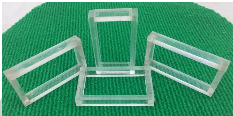
ภาพประกอบที่ 26 แบบอะคริลิกขนาด 30x60x10 มิลลิเมตร
