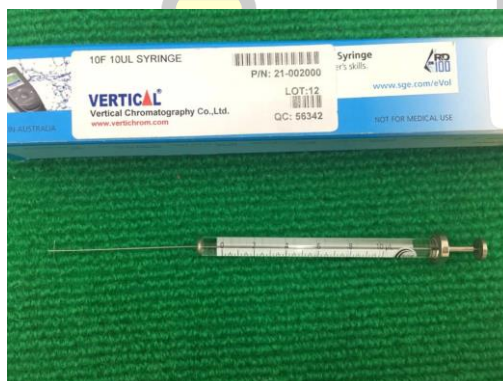
ภาพประกอบที่ 33 เข็มฉีดยาของเหลว ขนาด 10 ไมโครลิตร
