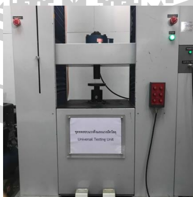
ภาพประกอบที่ 17 เครื่องทดสอบกำลังรับแรงกดอัดและความต้านแรงกดแตก
