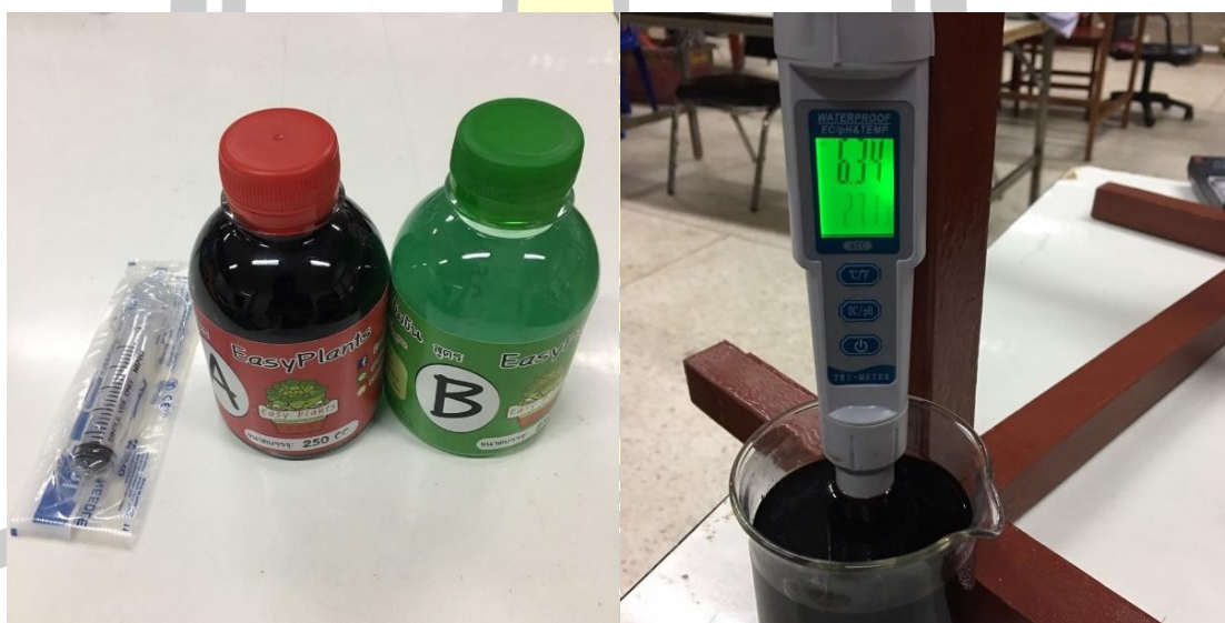
ภาพประกอบที่ 9 เซ็นเซอร์วัดค่าความอุดมสมบูรณ์และค่าพีเอช
