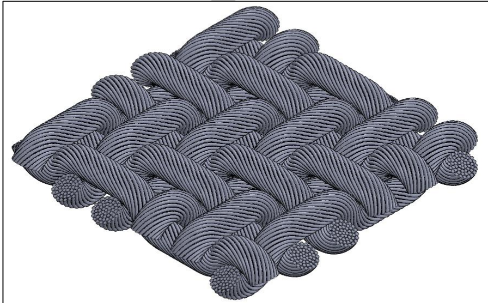
ภาพประกอบ 4.15 รูปแบบ CAD model โครงสร้างผ้าทอลายทแยงชนิด 2 x 2 (isometric)
