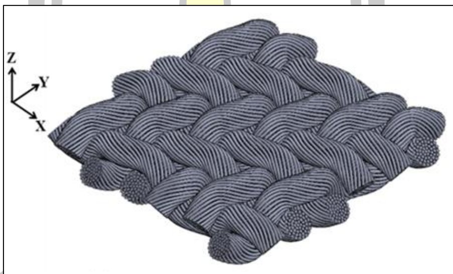
ภาพประกอบ 4.33 ภาพจำลอง 3D โครงสร้างผ้าทอลายทแยงชนิด 2 \times 2 แบบ skewness ในมุมมอง isometric view
