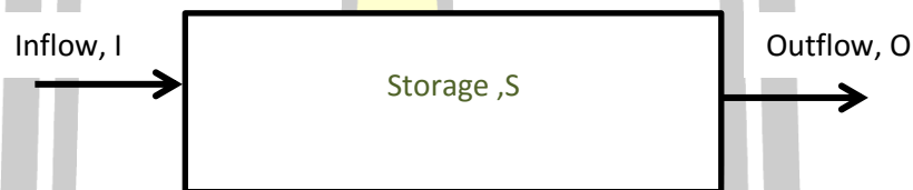
ภาพประกอบ 2.2 แบบจำลองอย่างง่ายของสมดุลน้ำ ที่มา: อนงค์ฤทธิ์ แข็งแรง (2553)
