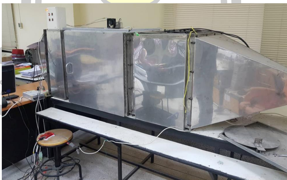
ภาพประกอบที่ 64 เครื่องอบลมร้อนสำหรับทดสอบการทำงานที่อุณหภูมิ 80 องศา
