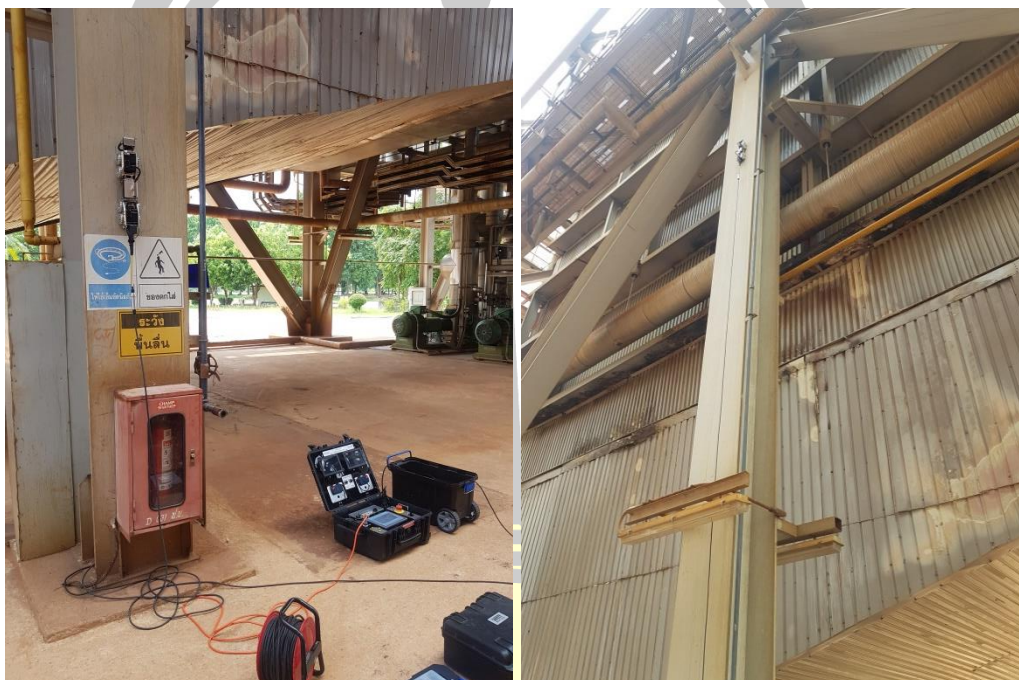
ภาพประกอบที่ 58 การทดสอบการเคลื่อนที่ในแนวดิ่ง
