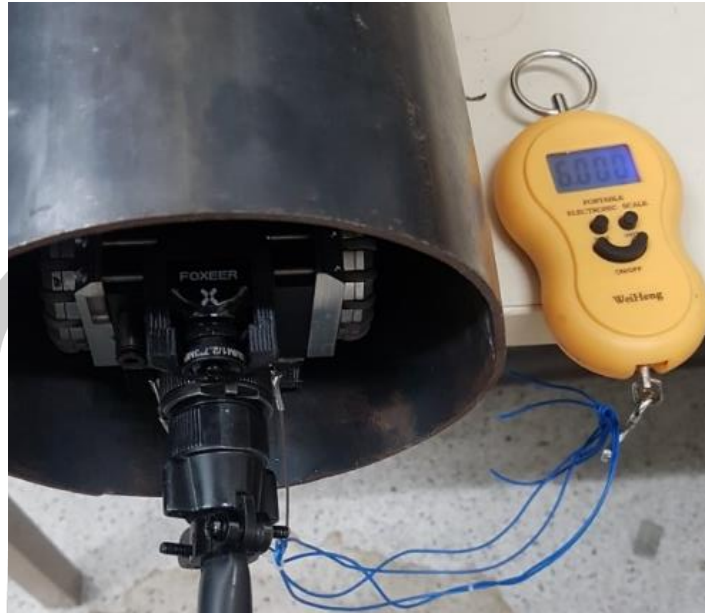
ภาพประกอบที่ 56 ผลการทดสอบแรงดึงในการเคลื่อนที่แนวระดับ
