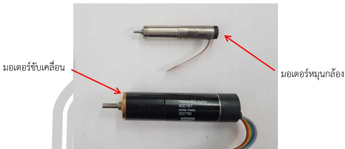
ภาพประกอบที่ 55 มอเตอร์สำหรับขับเคลื่อนและมอเตอร์สำหรับหมุนกลิ้ง
