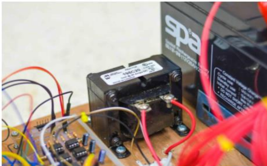
ภาพประกอบที่ 4.3 ตัวเหนี่ยวนำขนาด 1 mH 20 A [14]
