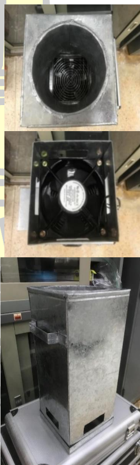
ภาพประกอบ 28 เครื่องฟอกอากาศไส้กรองแบบถ่วงบรรจุชิ้นส่วนโพลีเอทิลีน
