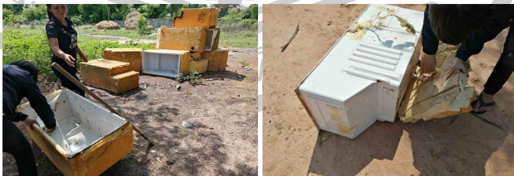
ภาพประกอบ 14 วิธีการแยกโฟมพียูออกจากโครงตู้เย็น
