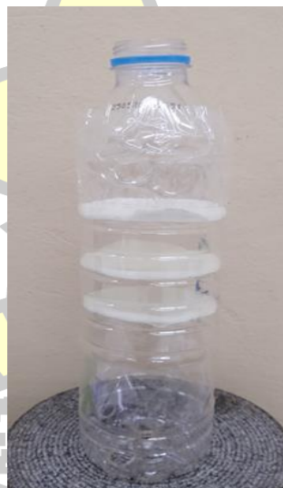
ภาพประกอบ 21 ชั้นไส้กรองโพลีเอทิลีนตัดเป็นแผ่นบาง
