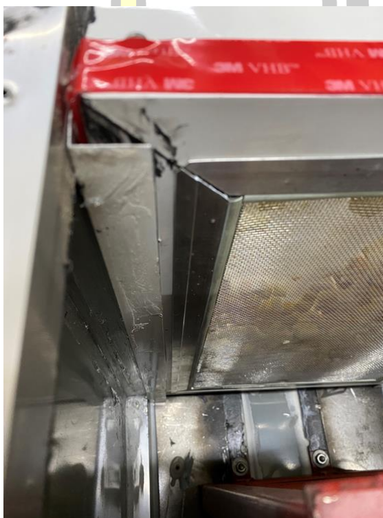
ภาพประกอบ 42 บริเวณที่เกิดการรั่วของอากาศ
