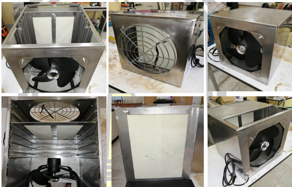
ภาพประกอบ 24 เครื่องต้นแบบเครื่องฟอกอากาศแบบไส้กรองแผ่นโฟมพียู
