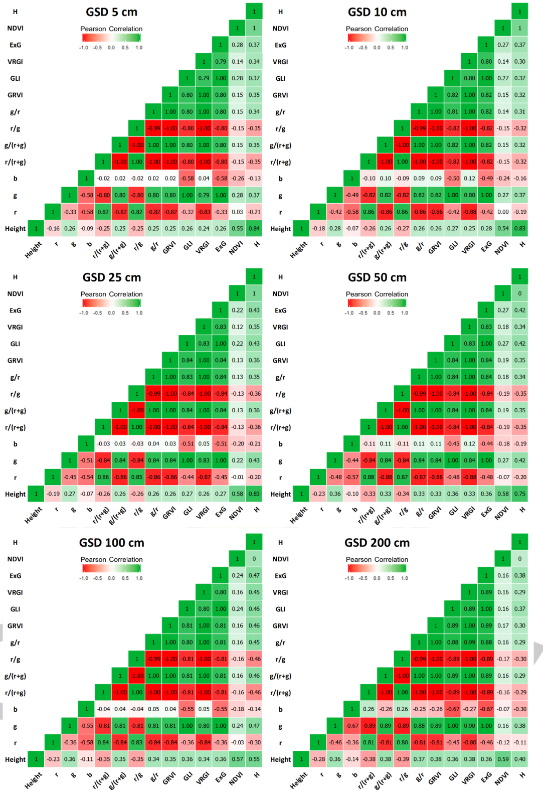
ภาพที่ 30 Correlation Heatmap ของความสัมพันธ์ระหว่างความสูง (Height) ต้นข้าวจากการวัด กับข้อมูลจากภาพถ่าย
