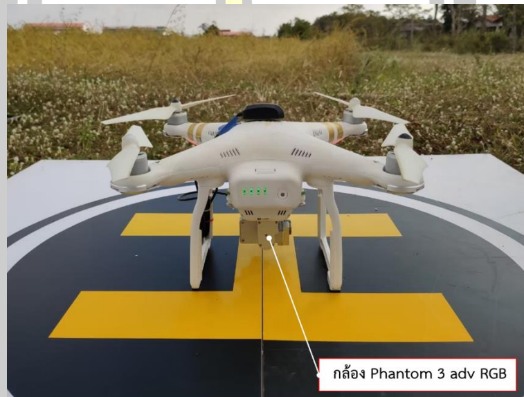
ภาพที่ 15 UAV ยี่ห้อ/รุ่น Phantom 3 Advance พร้อม กล้อง Phantom 3 adv RGB
