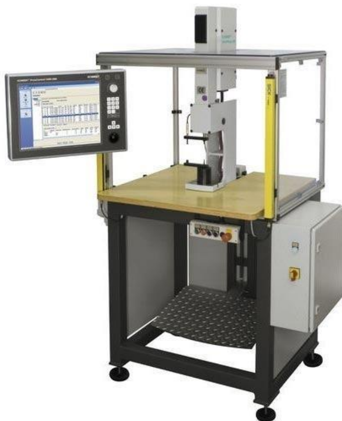
ภาพประกอบ 2. 5 ตัวอย่างเครื่องกดแบบใช้เซอร์โวมอเตอร์ [17]
