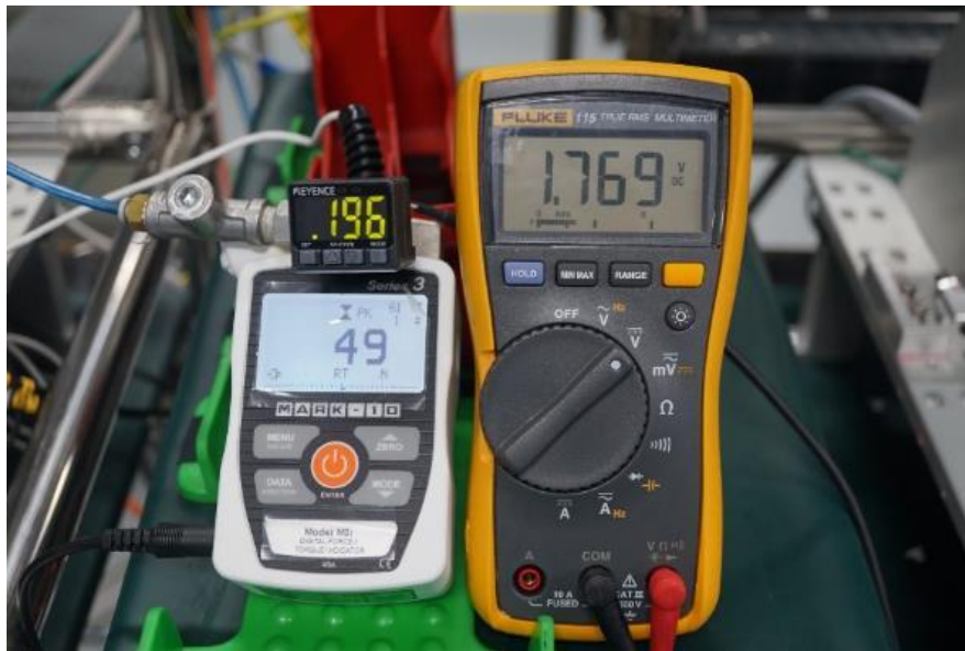
เครื่องมือวัดสำหรับวัดแรงกดของกระบอกลูกสูบ ค่าความดันอากาศ และค่าแรงดันไฟฟ้าของเซ็นเซอร์ วัดความดันอากาศ
