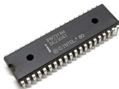
ภาพประกอบ 2.33 ไมโครคอนโทรลเลอร์ตระกูล MCS-51 [43]
