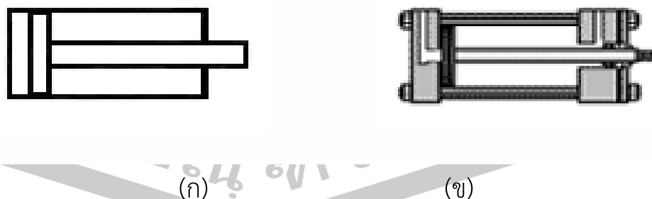
ภาพประกอบ 2.7 สัญลักษณ์และลักษณะภาพตัดกระบอกลูกสูบสองทาง [19]
