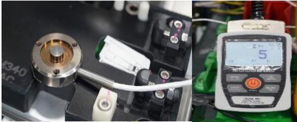
ภาพประกอบ 3.4 เครื่องมือวัดแรงกดของ cylinder [1]
