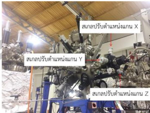
รูปที่ 3.45 แสดงตำแหน่งสเกลแกน X, Y และ Z สำหรับปรับค่าตำแหน่งในการวัดเนคซาฟ
