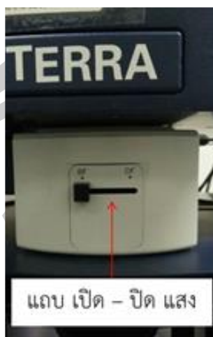
รูปที่ 3.41 แสดงการเปิดแสงในเครื่อง Dispersive Raman microscope
