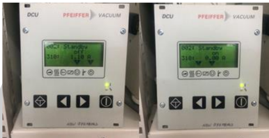
รูปที่ 3.32 แสดงการเปลี่ยนสถานะของ Turbo pump ให้อยู่ในโหมด Standby
