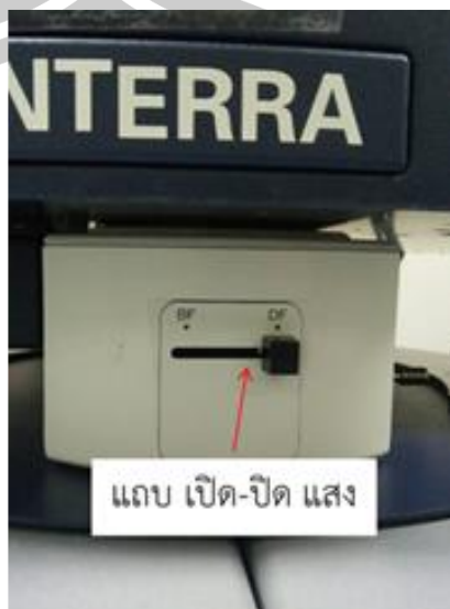
รูปที่ 3.39 แสดงการปิดแสงในเครื่อง Dispersive Raman microscope
