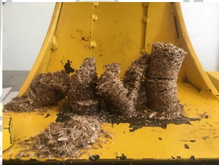
ภาพประกอบ 45 เชื้อเพลิง briquettes อัตราส่วน 100:0 ไม่สามารถขึ้นรูปได้
