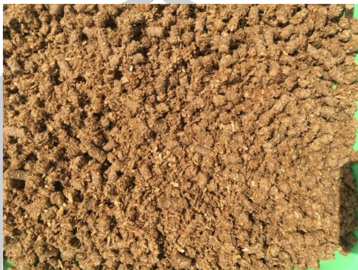
ภาพประกอบ 44 เชื้อเพลิง pellets อัตราส่วน 100:0 ไม่สามารถขึ้นรูปได้
