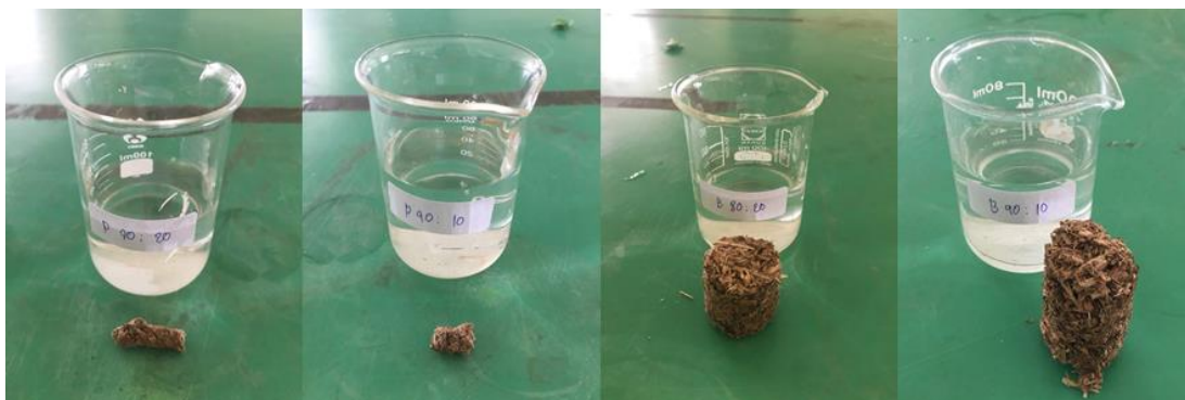
ภาพประกอบ 67 ลักษณะเชื้อเพลิงที่ไม่สามารถทนต่อการดูดซึมน้ำ
