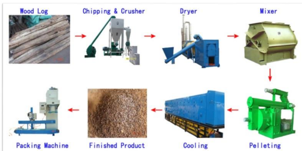
ภาพประกอบ 12 กระบวนการผลิตเชื้อเพลิงชีวมวลอัดเม็ด
