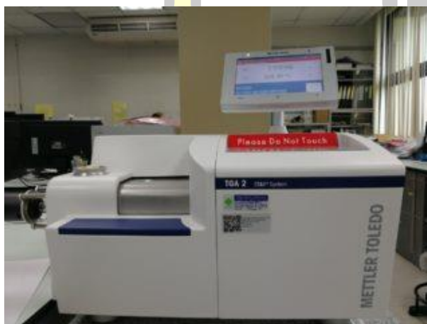
ภาพประกอบ 31 เครื่อง Mettler Toledo: TGA 2 ที่มา: ศูนย์เทคโนโลยีโลหะและวัสดุแห่งชาติ, 2563
