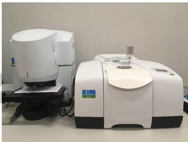
ภาพประกอบ 3.15 เครื่องวิเคราะห์ FTIR ยี่ห้อ PerkinElmer Spotlight รุ่น 200i/400
