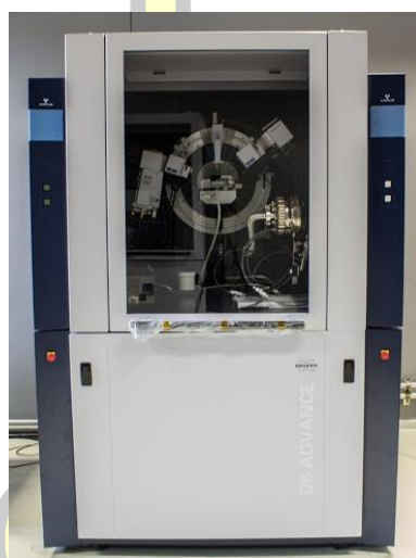
ภาพประกอบ 3.9 เครื่องวิเคราะห์ X-ray diffraction ยี่ห้อ Bruker รุ่น D8 Advance
