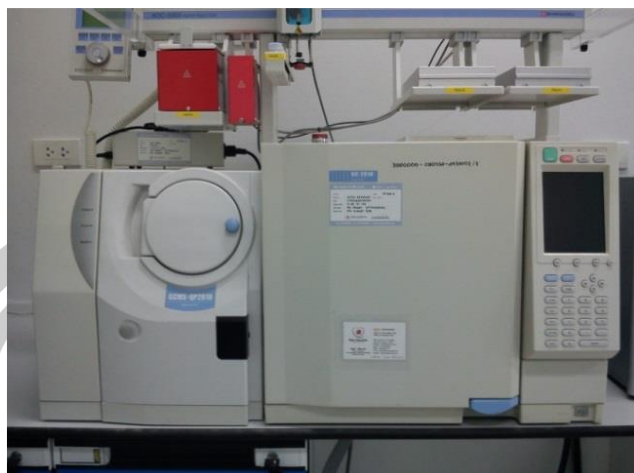
ภาพประกอบ 3.16 เครื่องวิเคราะห์ GC/MS ยี่ห้อ Shimadzu รุ่น QP-2010
