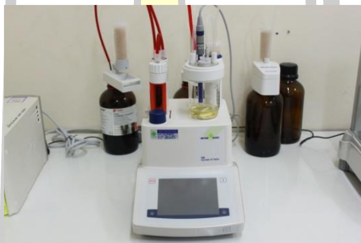
ภาพประกอบ 3.14 เครื่องวัดปริมาณน้ำยี่ห้อ Mettler Toledo รุ่น V20
