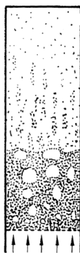
ภาพประกอบ 2.5 เครื่องปฏิกรณ์ชนิดฟลูอิดไคซ์เบดแบบฟอง
