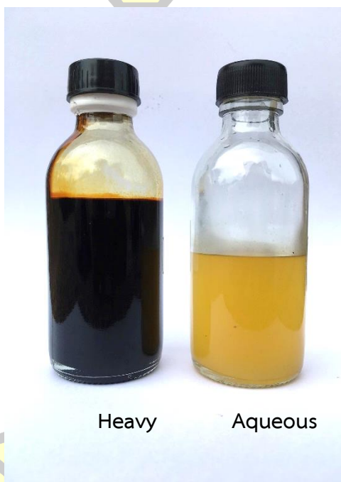
ภาพประกอบ 4.2 ไบโอออยล์เฟสต่าง ๆ ที่ผลิตได้จากกระบวนการไพโรไลซิสโดยไม่ใช้ตัวเร่งปฏิกิริยา
