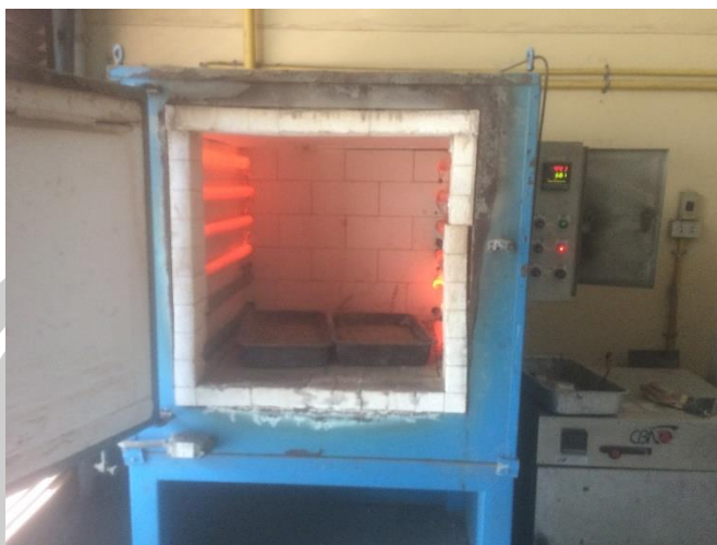
ภาพประกอบ ค 7 เเผตะกอนน้ำประปาที่อุณหภูมิ 600 องศาเซลเซียส เป็นเวลา 2 ชั่วโมง
