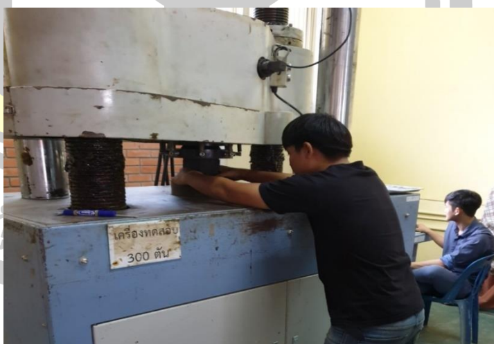
ภาพประกอบ ค 21 นำตัวอย่างทดสอบการรับกำลังด้วยเครื่อง UTM 300 ตัน
