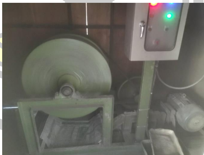
ภาพประกอบ ค 3 บดเก่าชานอ้อยให้ละเอียดด้วยเครื่องบดแบบตกรกระทบ
