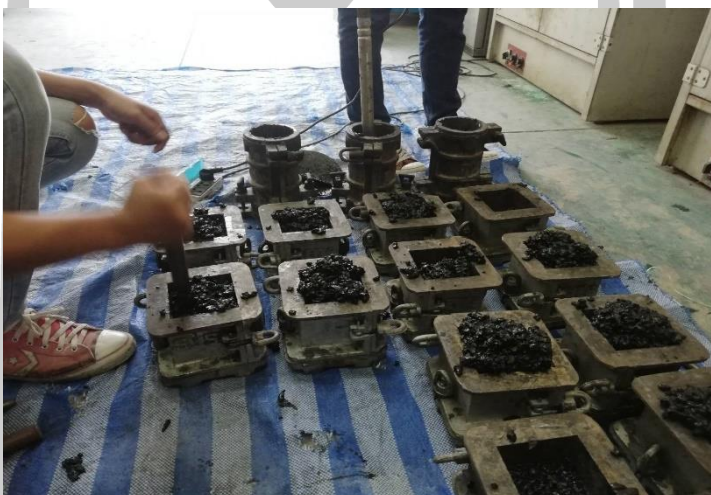
ภาพประกอบ ค 17 ใส่จีโอโพลิเมอร์คอนกรีตลงในแบบหล่อคอนกรีต
