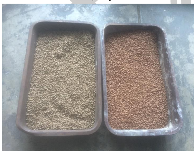
ภาพประกอบ ค 8 ตะกอนประปาหลังจากเเผที่อุณหภูมิ 600 องศาเซลเซียส (ถาดขวามือ)
