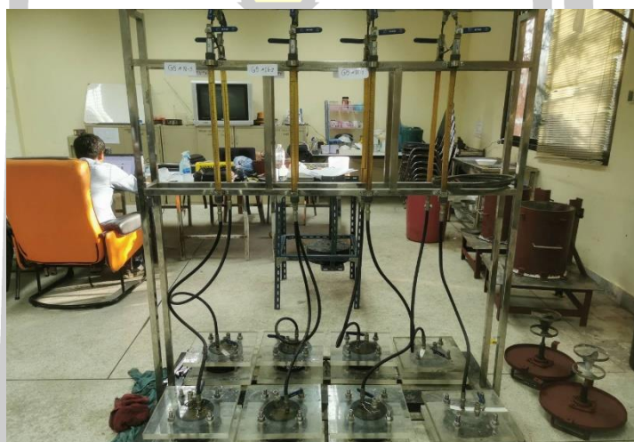
ภาพประกอบ ค 26 เครื่องทดสอบหาค่าสัมประสิทธิ์การซึมผ่านของน้ำ
