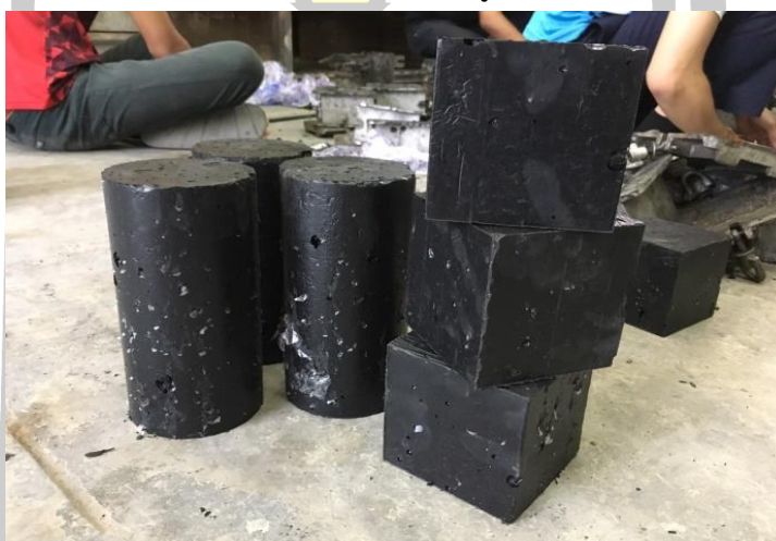
ภาพประกอบ ค 20 ลักษณะจีโอโพลิเมอร์คอนกรีตที่แกะออกจากแบบหล่อ
