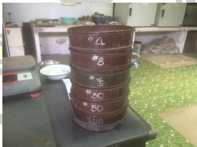
ภาพประกอบ ค 12 ชุดทดสอบหาค่าโมดูลัสความละเอียดของทราย
