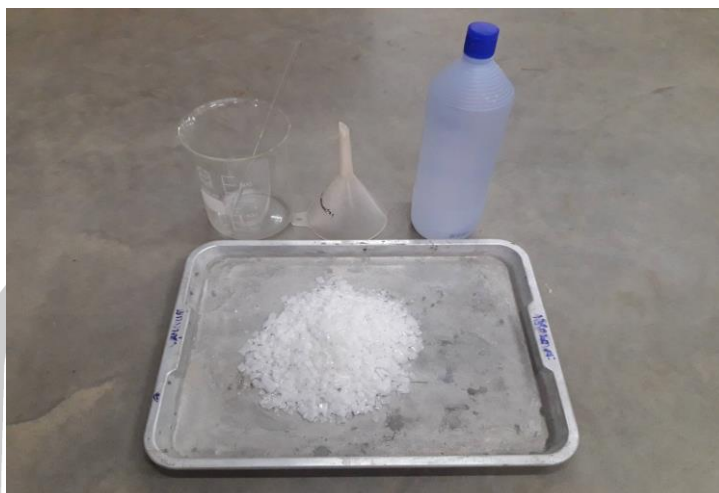
ภาพประกอบ ค 13 อุปกรณ์ในการเตรียมสารละลายโซเดียมไฮดรอกไซด์
