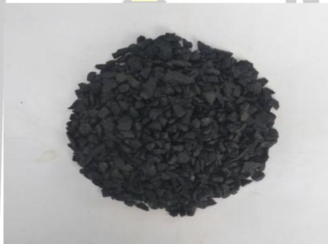
ภาพประกอบ ค 11 เตรียมหินบะซอลต์ ในสภาพอิมตัวผิวแห้ง
