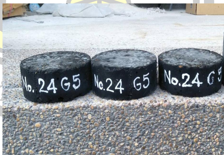
ภาพประกอบ ค 24 ตัดตัวอย่างเพื่อทดสอบหาค่าสัมประสิทธิ์การซึมผ่านของน้ำ
