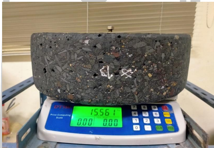
ภาพประกอบ ค 29 การชั่งน้ำหนักก่อนตัวอย่างขณะทดสอบหาค่าการสีกร่อน
