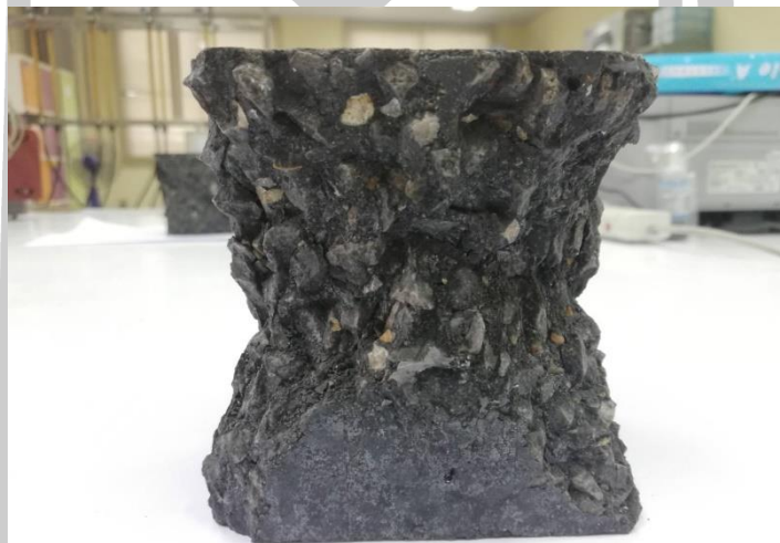
ภาพประกอบ ค 22 การทดสอบกำลังรับแรงอัดก้อนตัวอย่าง
