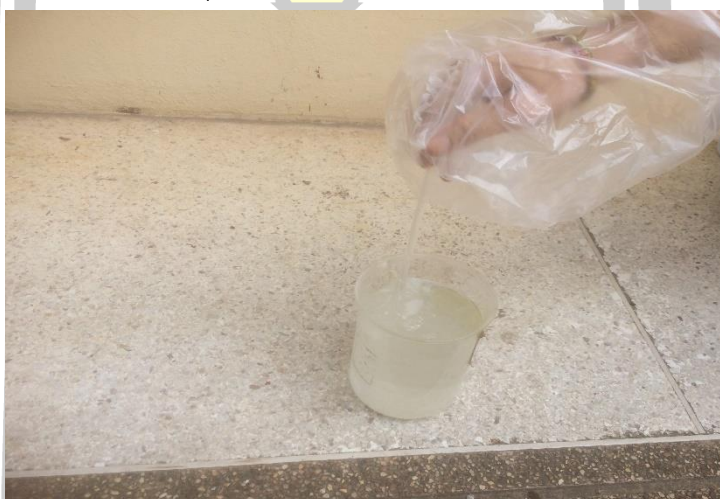
ภาพประกอบ ค 14 เตรียมสารละลายโซเดียมไฮดรอกไซด์ก่อนผสมอย่างน้อย 24 ชั่วโมง
