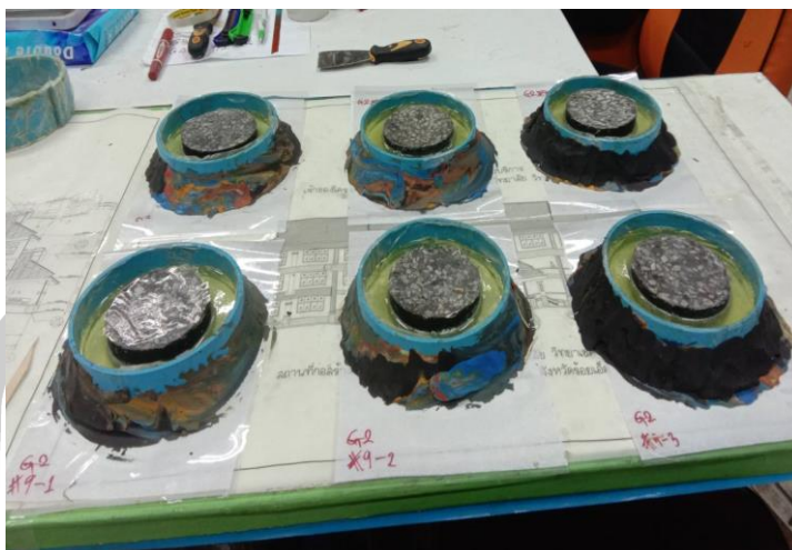
ภาพประกอบ ค 25 เตรียมตัวอย่างเพื่อทดสอบหาค่าสัมประสิทธิ์การซึมผ่านของน้ำ
