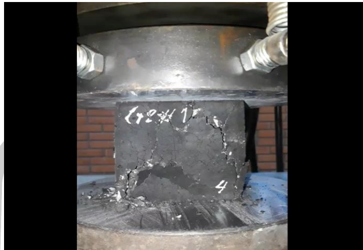
ภาพประกอบ ค 22 การทดสอบกำลังรับแรงอัดก้อนตัวอย่าง
