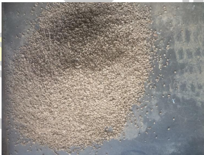
ภาพประกอบ ค 6 คัดแยกขนาดตะกอนน้ำประปาก่อนนำไปเผา
