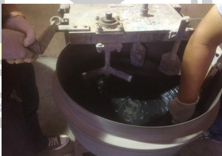
ภาพประกอบ ค 15 การผสมจีโอโพลิเมอร์โดยใช้เครื่องผสมคอนกรีต
