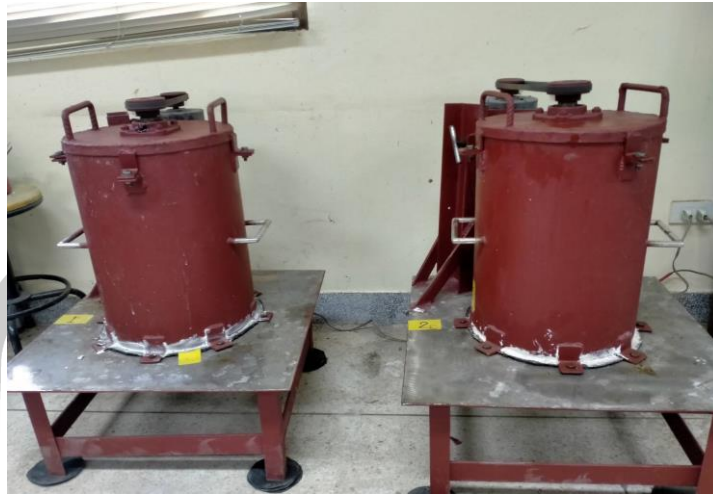
ภาพประกอบ ค 28 เครื่องทดสอบหาค่าการสีกร่อนของจีโอโพลีเมอร์คอนกรีต
