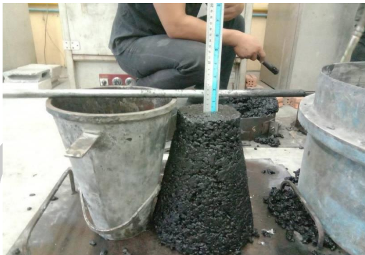
ภาพประกอบ ค 16 การทดสอบหาค่ายุบตัวของจีโอโพลิเมอร์คอนกรีต
