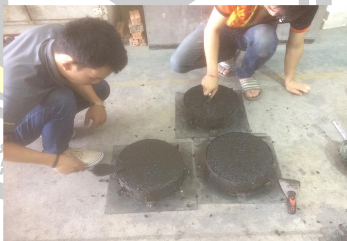
ภาพประกอบ ค 27 หล่อตัวอย่างเพื่อทำการทดสอบหาค่าการสีกร่อนของจีโอโพลิเมอร์คอนกรีต
