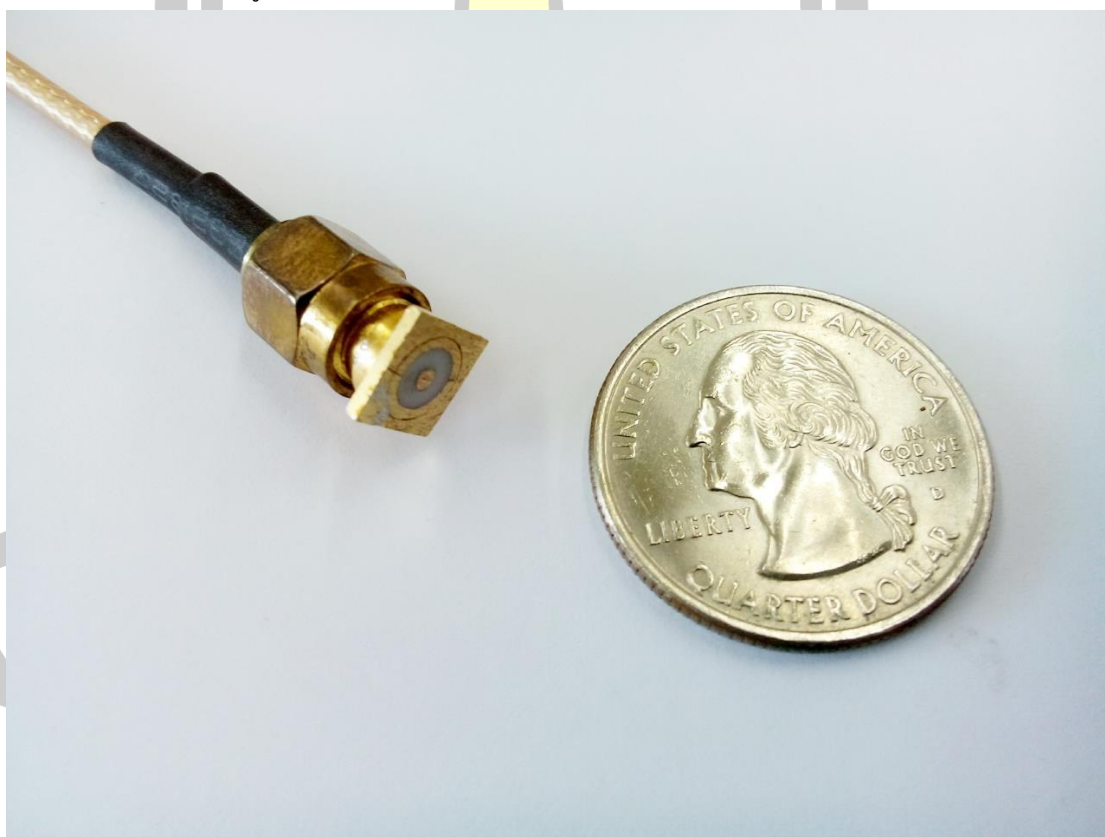
ภาพประกอบ 27 ลักษณะของเซนเซอร์ตัวเก็บประจุแบบแกนร่วมที่ดัดแปลงมาจากคอนเน็คเตอร์สำหรับยึดบนแผ่นวงจรพิมพ์ความถี่สูงแบบ SMA
