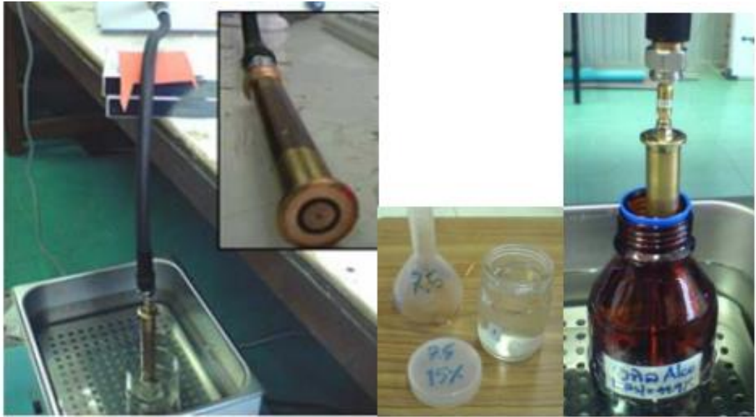
ภาพประกอบ 20 ตัวอย่างโพรบแกนร่วมแบบปลายเปิดโดยการออกแบบของ สมพร ศรีวิวัฒนพล
