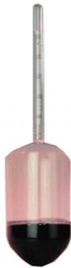
ภาพประกอบ 12 แสดงเครื่องมือวัดเมโทรแล็ค และวิธีใช้
