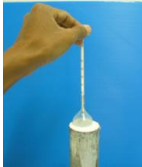
ภาพประกอบ 12 แสดงเครื่องมือวัดเมโทรแล็ค และวิธีใช้
