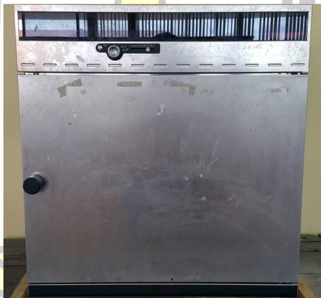
ภาพประกอบ 33 การอบแผ่นยางด้วยตู้อบอากาศร้อน ที่อุณหภูมิ 70 องศาเซลเซียส เป็นเวลา 16 ชั่วโมง
