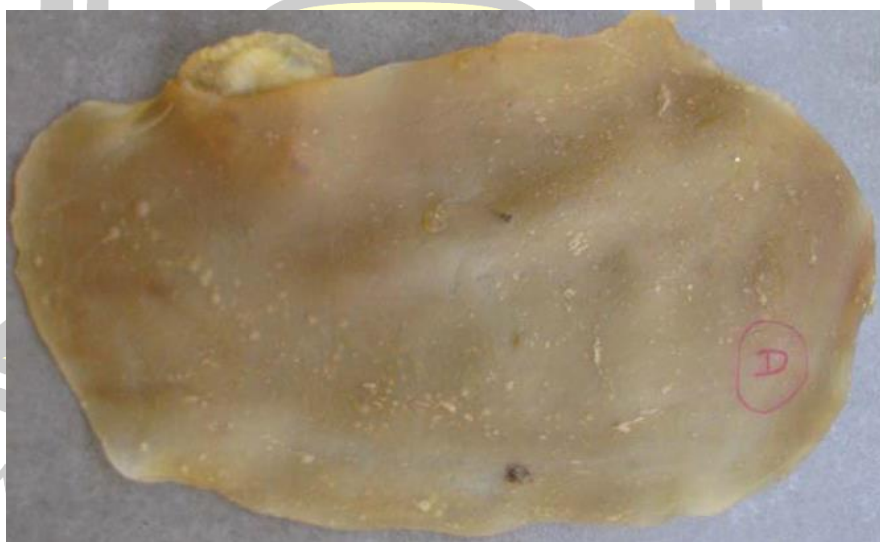
ภาพประกอบ 35 แผ่นยางแห้งที่พร้อมชั่งน้ำหนัก
