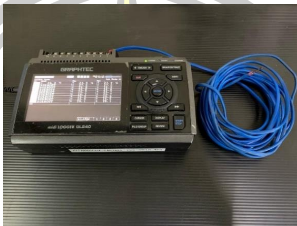
ภาพประกอบที่ 27 เครื่องบันทึกข้อมูลอัตโนมัติ และสายวัดอุณหภูมิ Type-K ขนาด 3.5 มม.
