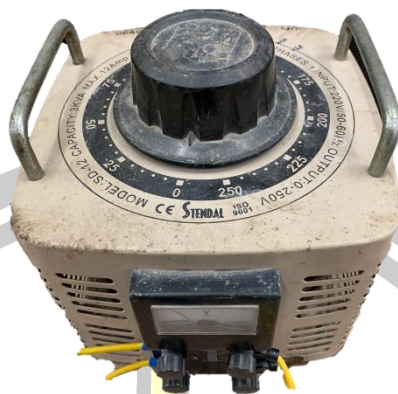
ภาพประกอบที่ 33 อุปกรณ์ปรับแรงดันไฟฟ้า ยี่ห้อ STANDAL Model: SD-12
