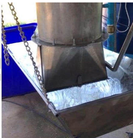
ภาพประกอบที่ 24 ลักษณะของการเพิ่มออกซิเจนในขณะที่น้ำไหลลงกระทรางรับน้ำ
