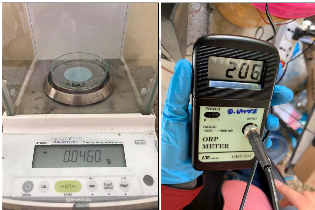
ภาพประกอบ ค7 การวิเคราะห์สารแขวนลอยในน้ำ (ซ้าย) การวัดค่าศักย์ภาพในการออกซิเดชันรีดักชัน (ขวา)
