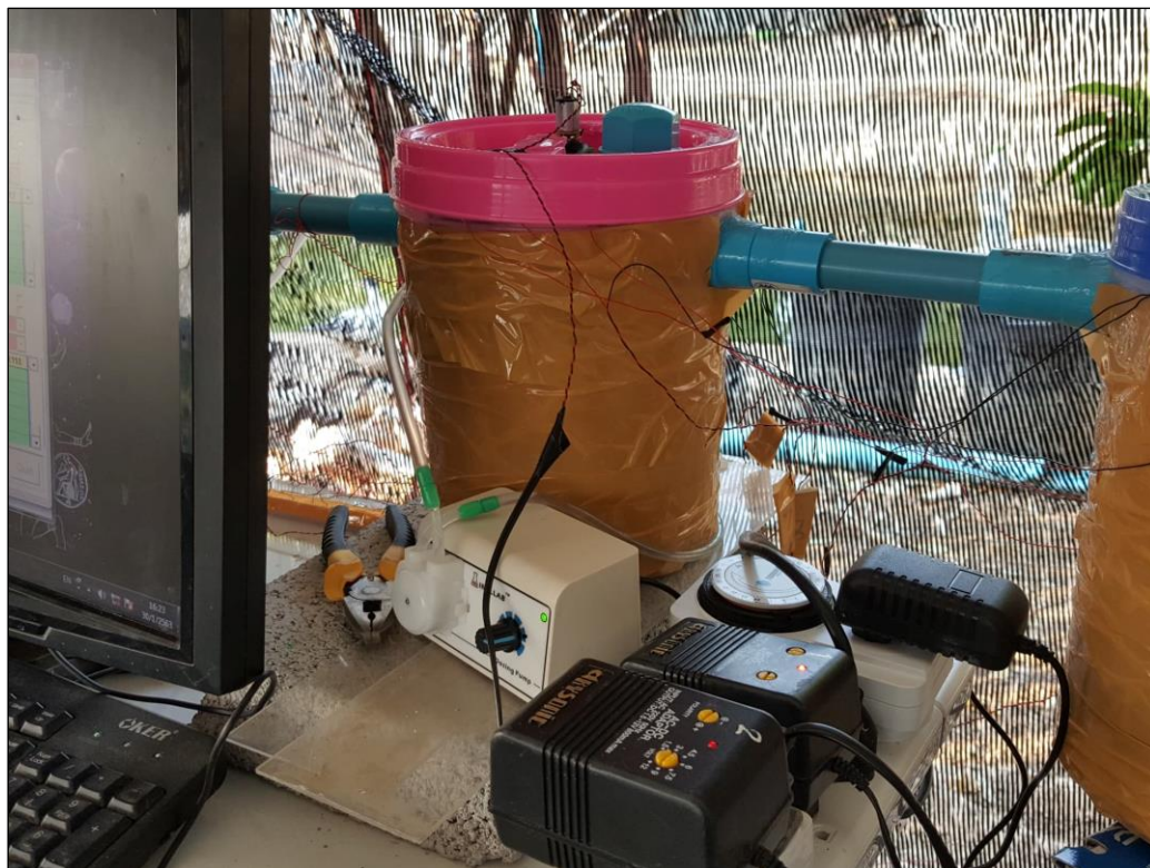
ภาพประกอบ ค3 การวางถัง anoxic ในระบบ Reverse A2O – MFCs
