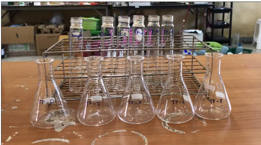
ภาพประกอบ ค9 การเตรียมเครื่องแก้วเพื่อวิเคราะห์ฟอสฟอรัสรวม
