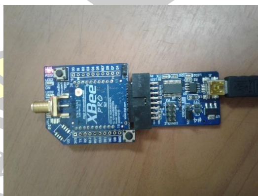
ภาพประกอบ 35 เชื่อมต่อชุดไมโครคอนโทรลเลอร์เข้ากับเครื่องคอมพิวเตอร์
