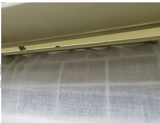
ภาพประกอบ 79 การทดลองที่สภาวะแผ่นกรองอากาศสกปรก
