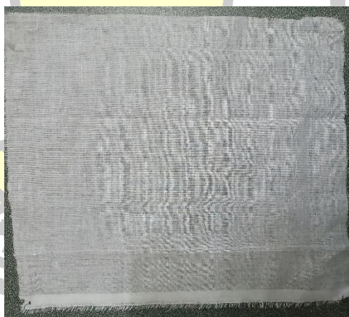
ภาพประกอบ 78 ผ้าขาวบางจำลองการสกปรกของแผ่นกรองอากาศในส่วนคอยล์เย็น
